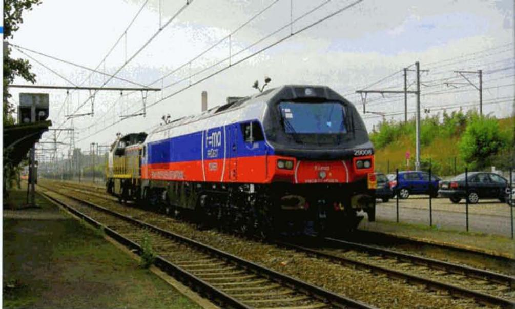
↑ PHOTO 118-34 Arrivée de la 29008 (TLMGE 004/2013) à l'atelier de Schaerbeek le 23 septembre, manoeuvrée par la 7783. Ce type d'engin est équipé d'un moteur Diesel GE type PE616 de 3700 HP, délivrant une puissance de 2750 kW. Pierre HERBIET.
