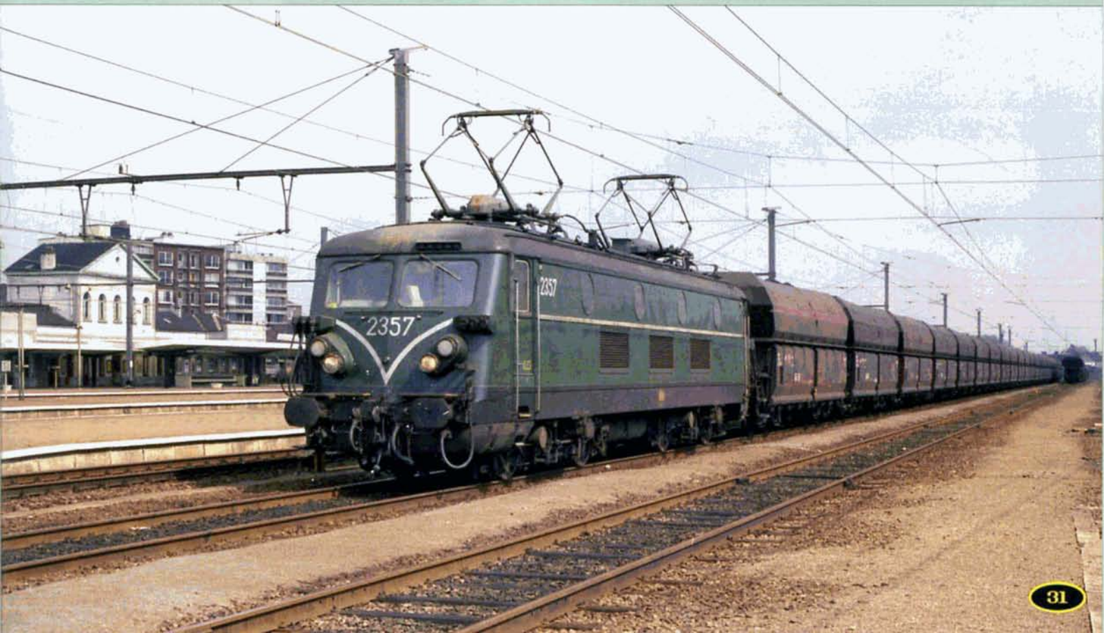
PHOTO 116-80 ↓ Le 21 avril 1987, un train de charbon stationne à Braine-le-Comte. Sur la 2357, le V en chrome a été remplacé par un V peint en blanc. C'est lors du placement des câblots d'unité multiple que cette moulure a été supprimée à la suite de la corrosion qui rongait la caisse à cet endroit. Au total, 33 machines ont reçu un V en peinture : les 2302, 2303, 2304, 2311, 2312, 2314, 2320, 2324, 2325, 2329, 2331, 2334, 2335, 2338, 2339, 2342, 2343, 2346, 2347, 2348, 2352, 2353, 2354, 2357, 2358, 2360, 2364, 2365, 2366, 2368, 2369, 2370 et 2371. Jean-Luc VANDERHAEGEN.
