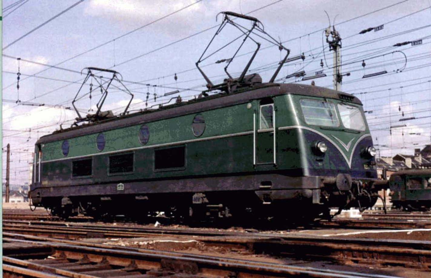
La 123.059 à Bruxelles-Midi dans son état initial. On remarquera qu'à l'origine, la longueur des mains courantes pour accéder aux cabines de conduite était plus courte. Elles furent par la suite allongées vers le bas pour faciliter l'accès. Photo Groupe SNCB.
