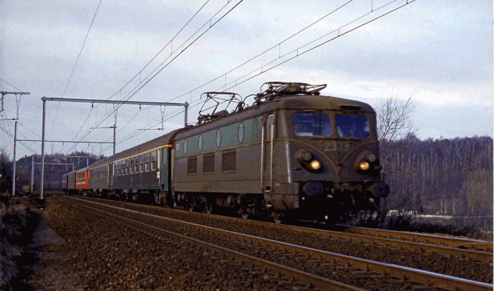
PHOTO 114-54 ↑ Le 17 décembre 1981, la 2339 remorquait l'Express 143 "Le Schuman" Bruxelles-Midi - Luxembourg, en passage à la bifurcation de Louvain-la-Neuve, à la sortie d'Ottignies. La rame est composée, dans l'ordre, de deux voitures du type I4 de 1 e classe, d'une voiture-buffet du type I2 et de deux voitures du type K3 (2 e classe). Pierre HERBIET.
