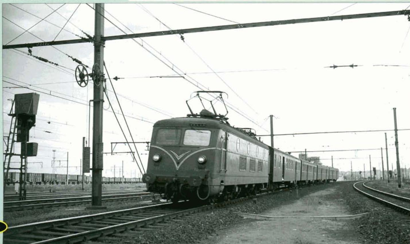
→ En 1956, la 123.001 quitte Oostende en tête d'une rame de voitures du type M1. La locomotive a reçu le petit V au milieu de sa face avant. Ce petit V fut ajouté dans le but de distinguer les types 123 des types 122. Les 122 ne pouvaient en effet pas circuler sur la ligne du Luxembourg. ACEC.
