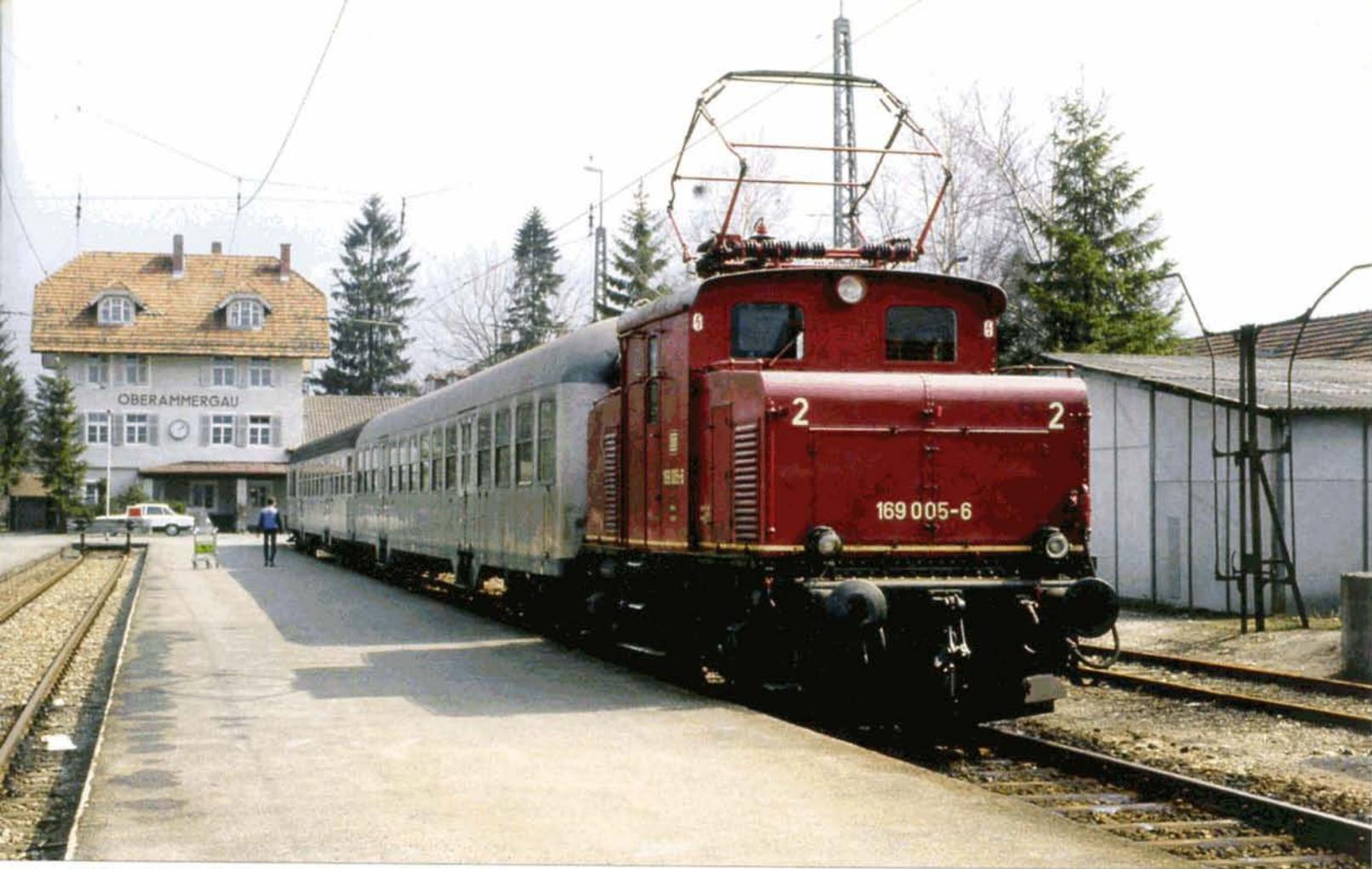
**PHOTO 113-67** ↑ Le départ est proche pour la 169 005 en gare d'Oberammergau. Les capots de cette machine étaient beaucoup plus grands que ceux des quatre premières locomotives. Sa masse totale s'élevait à 32 t contre 23 à 26 t pour les autres. Pierre HERBIET.
