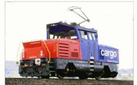
La nouvelle locomotive hybride Eem 923 001 (constructeur Stadler, effectif 30, vitesse 100 km/h, 1500 kW, moteur Diesel 290 kW, tension 15 et 25 kV). SBB CFF FFS.
