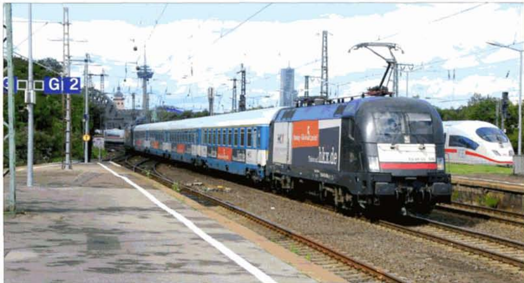
PHOTO 112-48 Le 25 août, passage à Köln Deutz du train HKX 1803 Köln Hbf 12.01 - Hamburg Altona 16.23. La rame, composée de seulement quatre voitures, est encadrée par deux ES64U2 fonctionnant en unité multiple ! Les trains HKX desservent les gares de Dusseldorf Hbf, Duisburg Hbf, Essen Hbf, Gelsenkirchen Hbf, Münster Hbf, Osnabrück Hbf, Hamburg-Harburg et Altona. Tim VAN ROOY.
