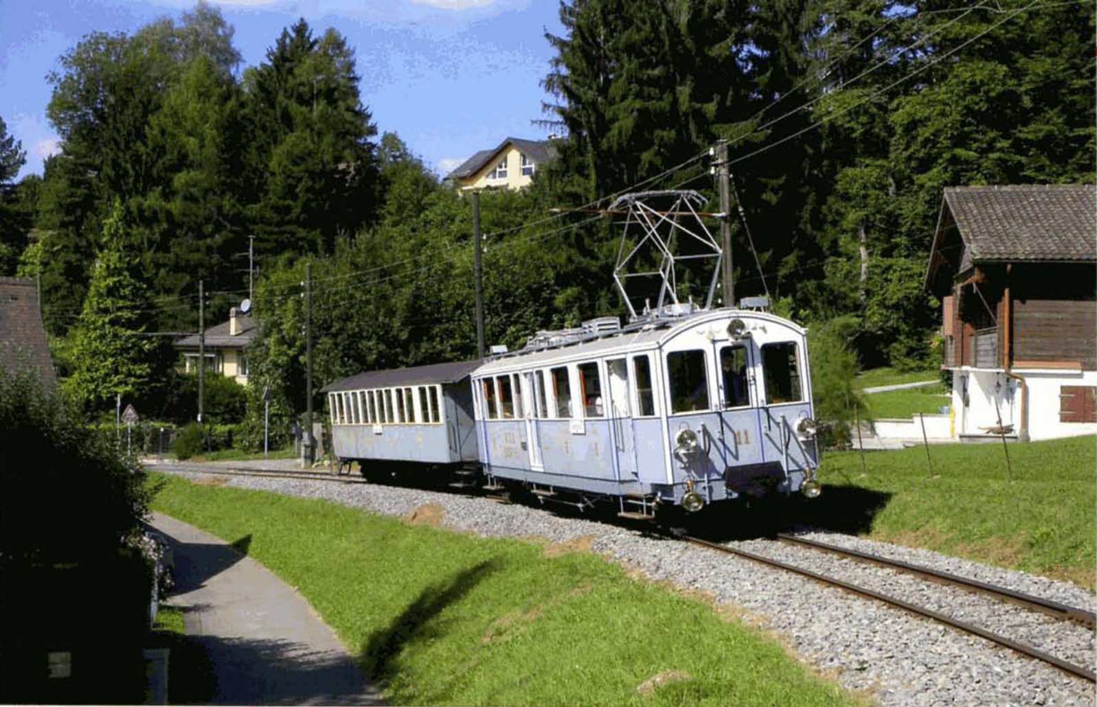
PHOTO 112-54 La superbe automotrice ABDe 4/4 11 du MOB, à Chantemerle, en route de Blonay vers Chamby, le 15 septembre. Elle fut mise en service en 1911, peut circuler à 50 km/h, dispose de 250 kW et pèse 29 t. Michel HANSENS.
