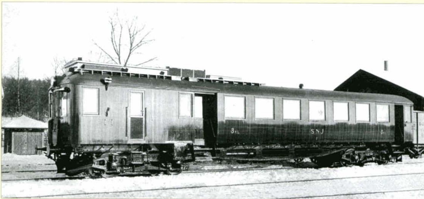
Autorail diesel-électrique de 120 CV livré par ASEA au réseau privé du Stockholm - Nynäs Järnväg (SNJ) en 1928. Le 650.01 de la SNCB qui sera livré en 1932 ressemble beaucoup à ce véhicule. Les bogies sont identiques. Photo SJ.
