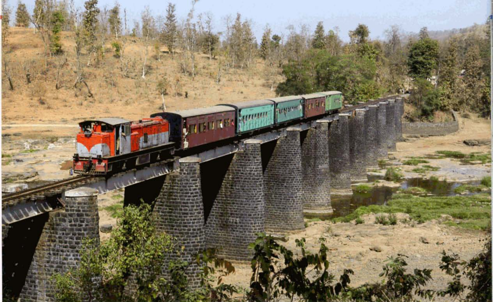
↑ PHOTO 112-61 Le 20 février 2012, à Durgada, dans le parc national de Vansda, la ZDM5-511 franchit la rivière Ambika avec un train Waghai - Bilimora. Les ZDM5 (Z: voie de 762mm, D: Diesel, M: services mixtes) sont des B-B construites par Chittaranjan à partir de 1989. Elles disposent de 450kW et peuvent circuler à 50km/h. Jean-Luc VANDERHAEGEN.
