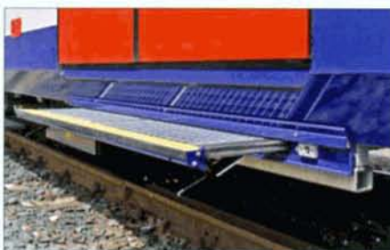
Le marchepied coulissant (portes 9 et 10) donnant accès à l'espace multifonctionnel.
