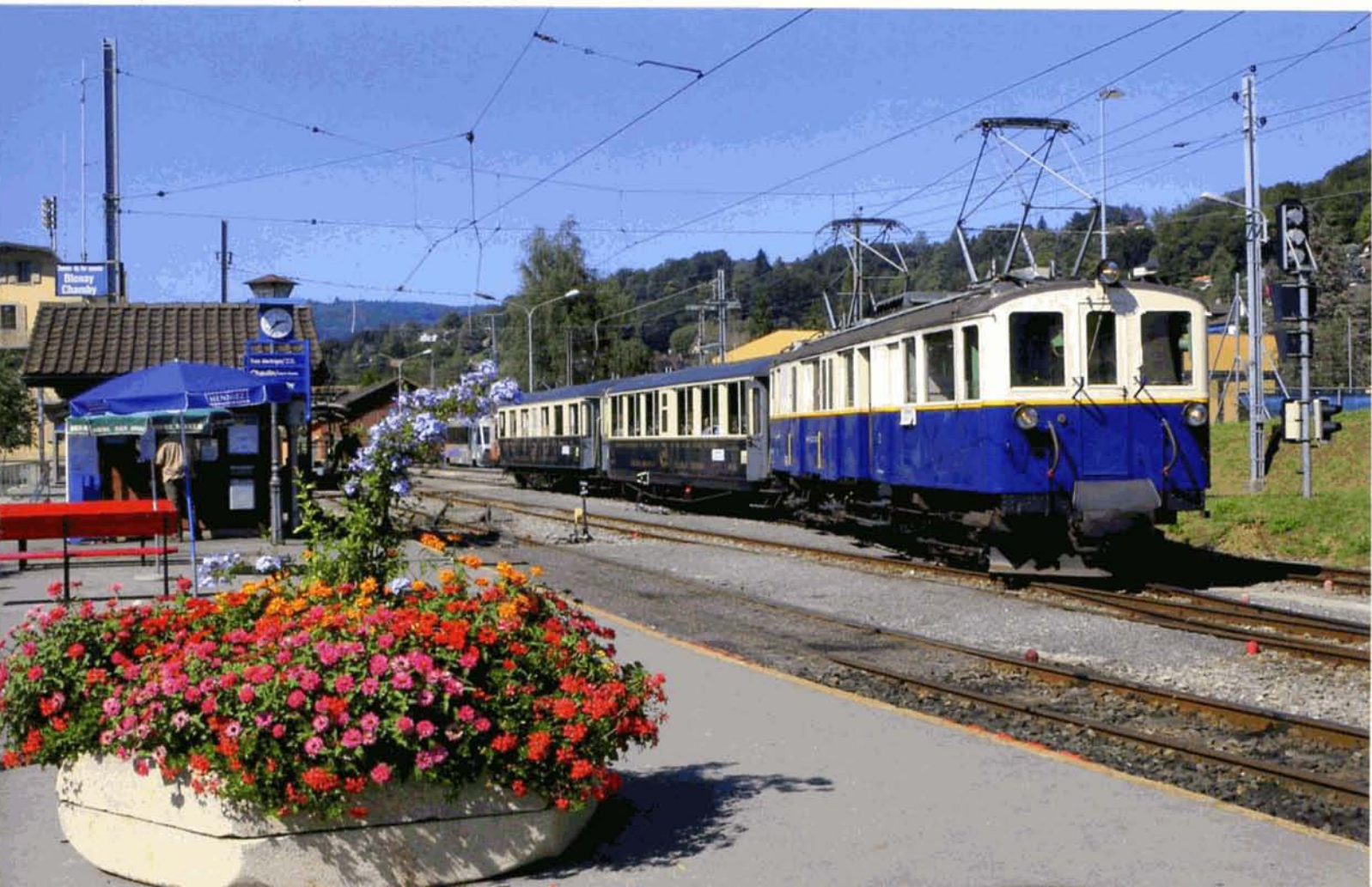
PHOTO 112-55 Le 16 septembre, l'automotrice MOB BDe 4/4 28 accouplée aux deux voitures historiques Pullman en provenance de Vevey, attend le départ à Blonay pour Chamby. Elle fut mise en service avec la BDe 4/4 27 en 1924. Puissance 388 kW, vitesse 50 km/h, masse totale 36,2 t. Michel HANSENS.
