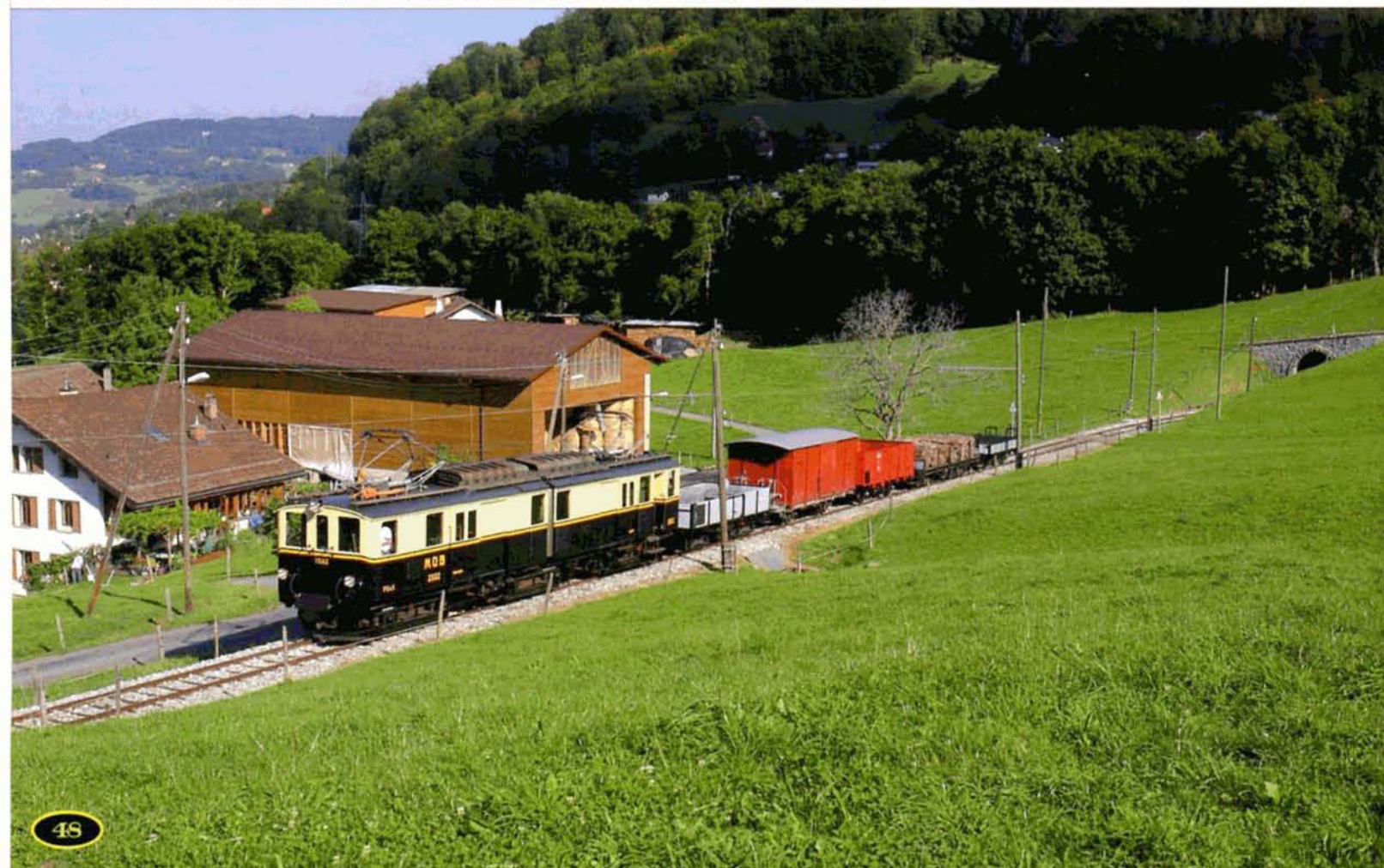
PHOTO 112-53 Le fourgon-moteur articulé MOB DZe 6/6 2002 remorque un train de marchandises entre Chamby et Blonay. Les deux fourgons de ce type (2001-2002) furent mis en service de 1932 à 1933. Les deux caisses sont articulées sur trois bogies. Puissance 737 kW, vitesse maximale 60 km/h, masse totale 62,8 t. Cornaux, 15 septembre. Michel HANSSSENS.
