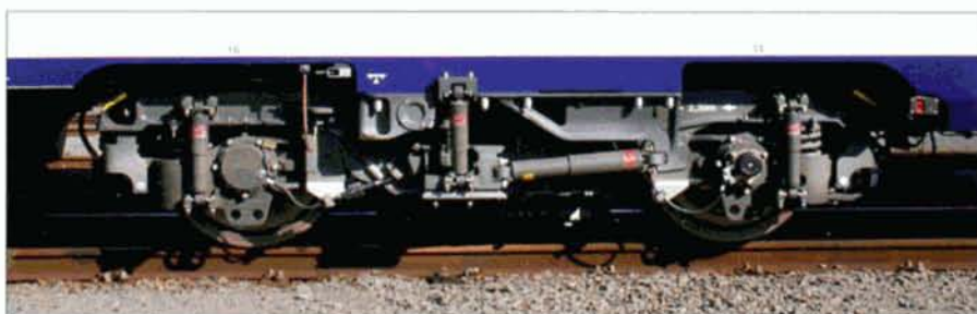
Les bogies porteurs et moteurs sont pratiquement identiques. Ici, un bogie porteur, lequel comprend deux patins de freinage électromagnétique situés entre les roues sous le châssis du bogie.
