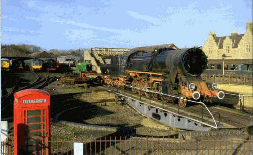
**PHOTO 103-05** Pour permettre son chargement sur la remorque routière, la Ty2-7173 a dû être virée sur la plaque tournante de Wansford, le 11 mars 2011. PFT / Thierry SIMON.
