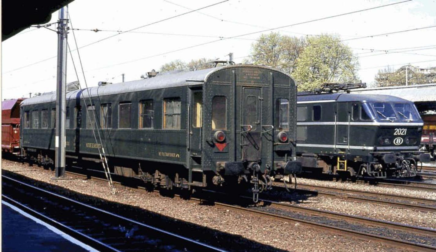
**PHOTO 103-59** ↑ La voiture de mesure n°11 en gare de Namur le 17 avril 1981. Sa porte centrale et ses pantographes ont été démontés en 1975. Cette voiture a eu la particularité d'avoir été utilisée en France lors des parcours d'essai des locomotives électriques pour la Corée du Sud (BBB de construction Alstom, MTE, ACEC et BN Nivelles). Pierre HERBIET.
