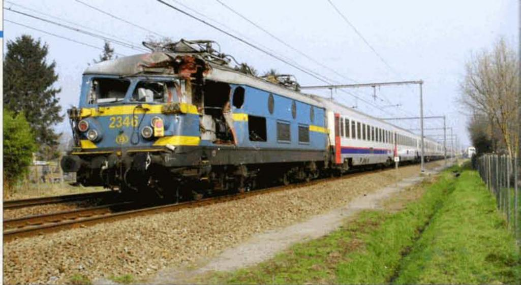
**PHOTO 103-99** Le 1er mars, la 2346 a été éventrée par la flèche d'une grue qui se trouvait dans le gabarit de la voie à hauteur d'un passage à niveau à Wilsele. Simon DERIDDER.
