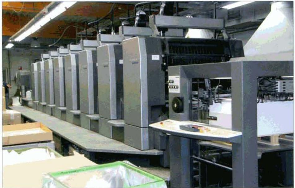
Ci-dessus : la presse Heidelberg sur laquelle est imprimé le *EN LIGNES* 97. La machine comprend 8 unités placées les unes derrière les autres. Chacune des 8 plaques est placée dans une unité. A droite on voit le chargeur de papier. Ci-dessous : la plaque magenta enroulée autour de la rotative.
