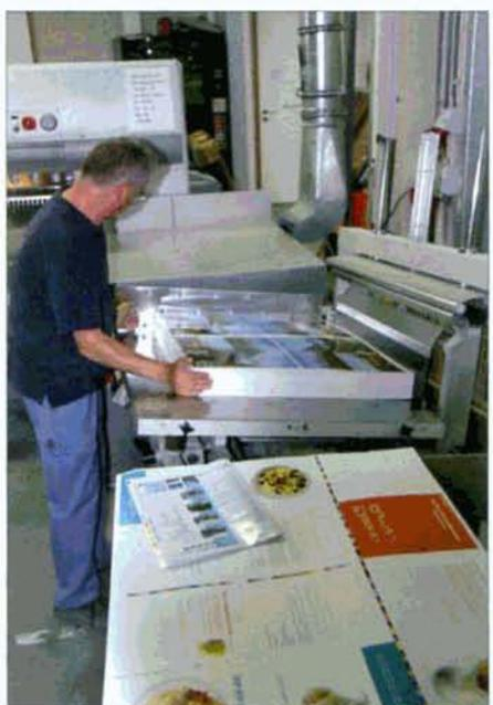
Avant découpage, les rames de feuilles passent sur une machine permettant de former un bloc où les feuilles sont parfaitement ajustées.
