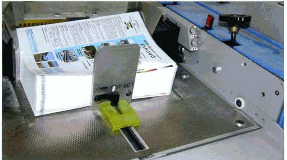
Une pile de cahiers. Ici, les pages 3 à 10 et 59 à 66, sont placées dans un des chargeurs de la machine d'assemblage.
