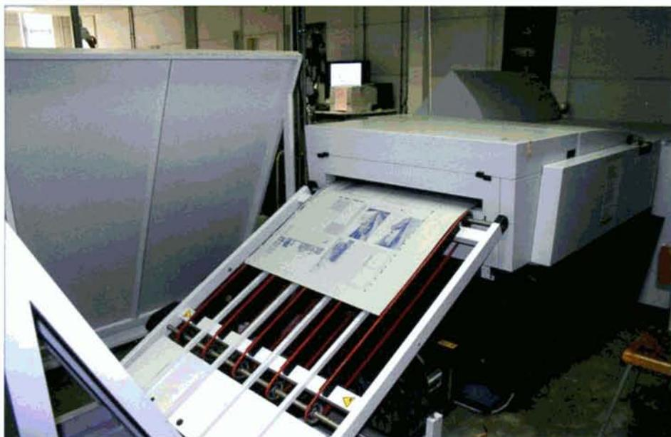
Les plaques sont réalisées par deux installations Heidelberg Computer-to-Plate. Ici, sortie d'une plaque cyan (bleu).
