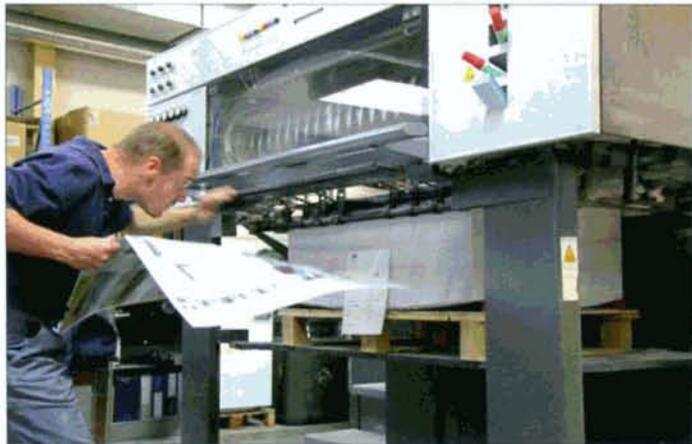
Photos colonne de gauche : tout au long du tirage, des contrôles de qualité sont effectués. En haut : retrait d'une feuille. Au milieu et en bas, les deux installations de contrôle.
