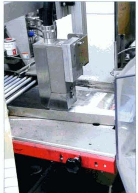
↑ En fin de chaîne, les adresses des abonnés sont automatiquement imprimées à l'aide d'une tête d'impression digitale.
