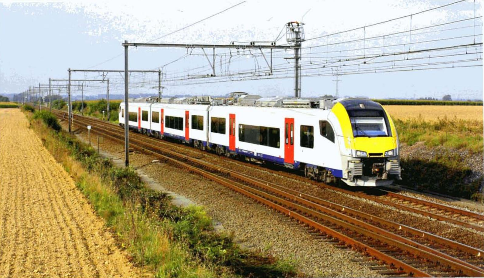
**PHOTO 100-11** L'automotrice Desiro 08502 a poursuivi ses essais pour l'homologation de la série. Du 13 au 17 septembre, elle fut testée sous 25 kV entre Bertrix et Virton, pour vérifier la "captation de courant avec un pantographe 25 kV modifié". Du 23 au 25 septembre, elle effectua les tests de compatibilité électromagnétique sous 3 kV au bois du Coucou entre Silly et Ath. Cette photo montre la 08502 sur le site du Coucou, le 24 septembre. Christian AUQUIERE.
