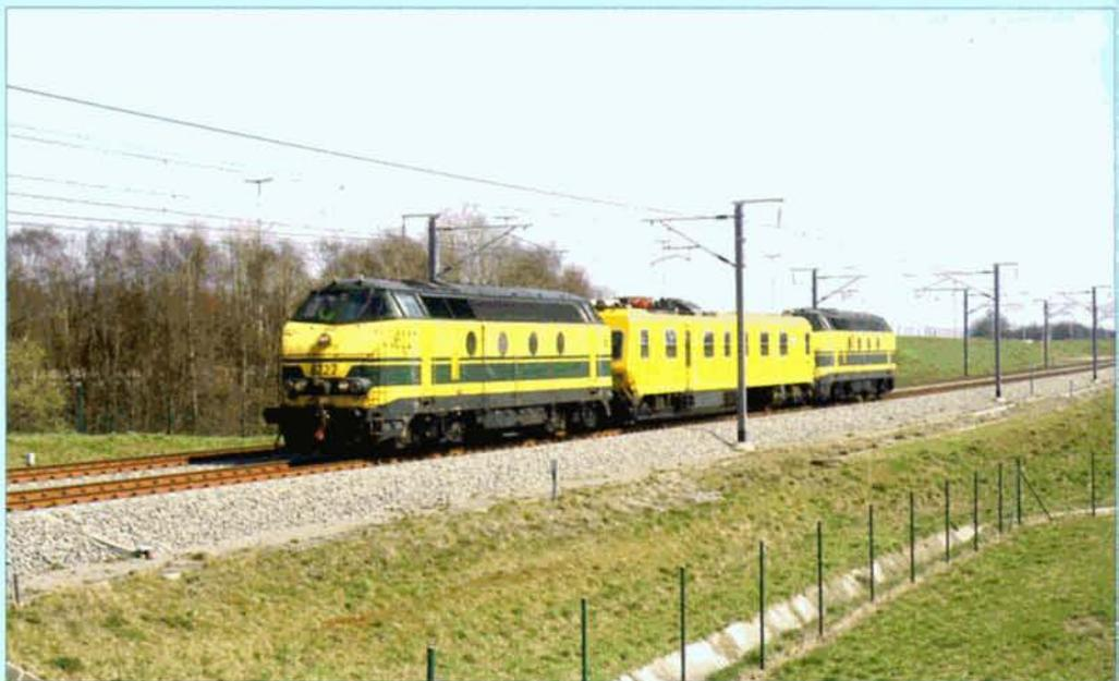
**PHOTO 100-36** Pour assurer les trains de secours, la SNCB a transformé six locomotives de la série 55 pour la L1, et 4 locomotives de la série 62/63 pour la L2. Le 6 avril 2006, passage à Berlooz, sur la L2, d'un train de mesures composé de l'autorail EM130 encadré par la 6227 et 6225. Michel HANSENS.
