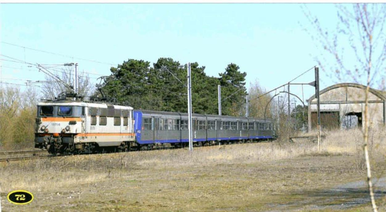
*Service TER pour une machine au passé hors norme : la 16786 fut l'une des deux unités (avec la 16785) équipées du multiplexage afin d'effectuer la pousse (avec UM en tête) des trains de 3600 t sur l'artère Nord-Est. Gilbert LAURENT.*
