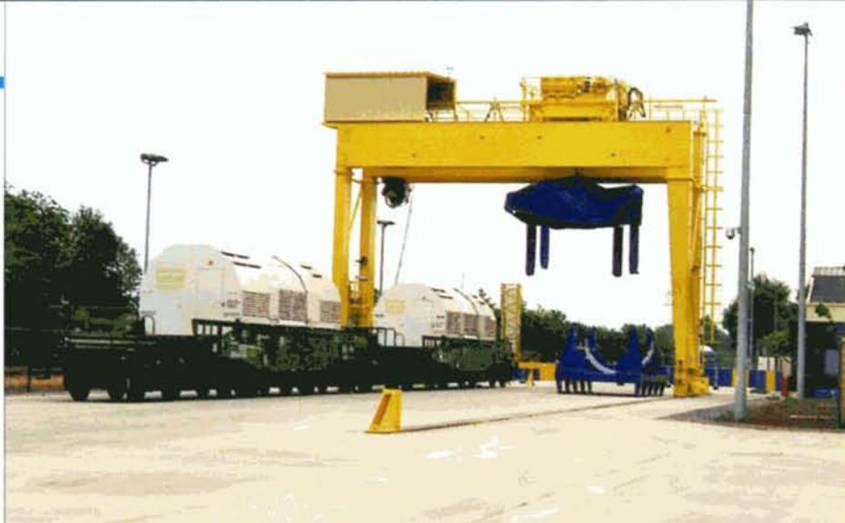
En gare de Mol, le nouveau portique de levage pour les conteneurs transportant des déchets radioactifs, a été mis en service. Ces conteneurs sont transportés sur des wagons spéciaux à 8 essieux (4 bogies) construits par Arbel Fauvet Rail à Douai en 2009, et immatriculés à la SNCF. A noter que cette impressionnante usine qui a construits des milliers de wagons, également pour la SNCB, a récemment été déclarée en faillite. Roger CRIKELAIRE.
