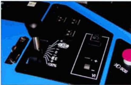
**Le manipulateur traction/freinage.**
