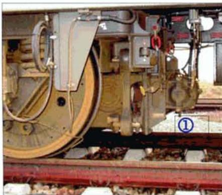
Les garnitures de frein agissent sur deux disques bloqués sur un axe parallèle à l'essieu, reliés à l'arbre creux de l'essieu par des engrenages. Cette photo montre en ① le cylindre de frein. Eric VANHOECK.
