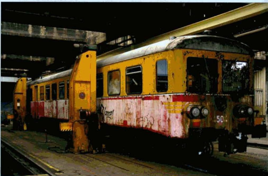
Un des deux moteurs Diesel du 4504 sera récupéré pour réparer le 4506 dont un des moteurs pose problème. Le voici à Stockem lors du levage. Michel DEMOULIN, 8 avril 2009.
