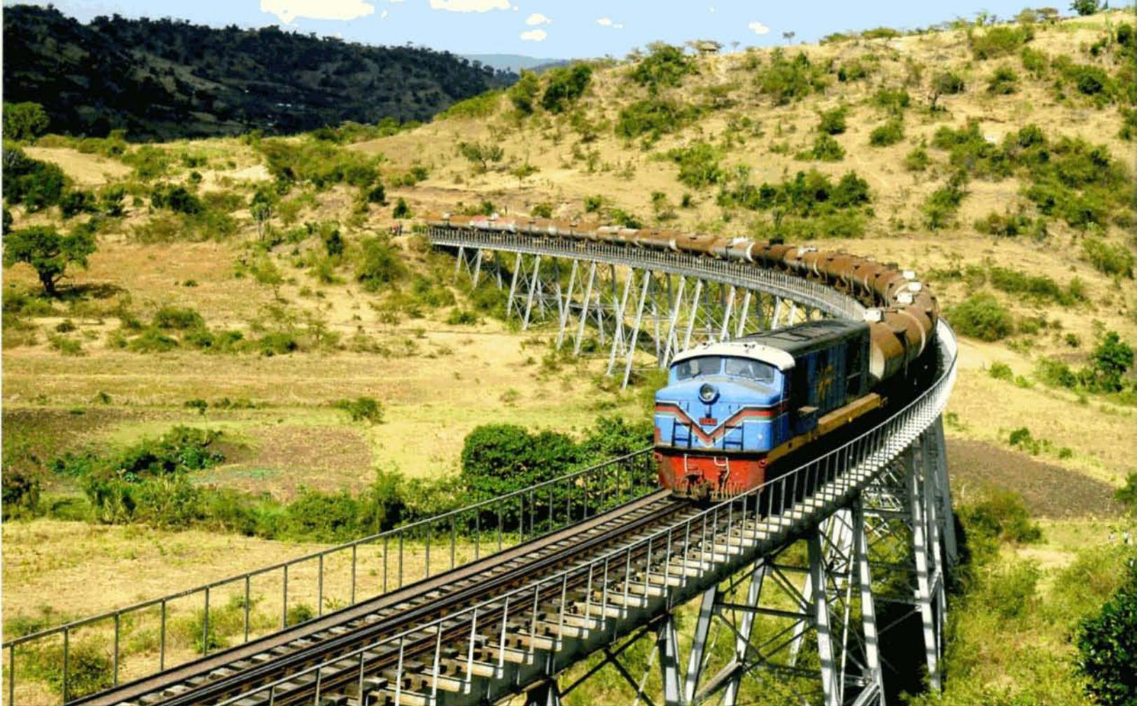
**PHOTO 91-51** Les locomotives Diesel les plus remarquables des KR sont les 1CC1 de la série 8700, construites par English Electric de 1960 à 1968. Elles développent 1370 kW pour une masse totale de 101,5 t et une vitesse limitée à 72 km/h. Seules quelques machines sont encore utilisées. Le 17 janvier 2009, la 8740 en tête d'un train de citernes franchit une superbe viaduc à Fort Ternan. Yves STEENEBRUGGEN.
