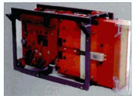
↑ Le disjoncteur principal à courant continu. Il est logé dans l'armoire haute tension 3 kV.
