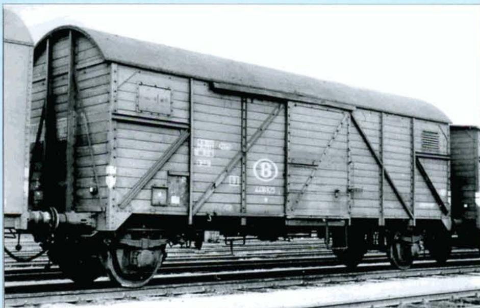
Le wagon SNCB 4.416.926 type 2021. Il s'agit d'un ex. fourgon Pwgs-43 transformé en wagon fermé type «Bremen». Collection Charles OCSINBERG.
