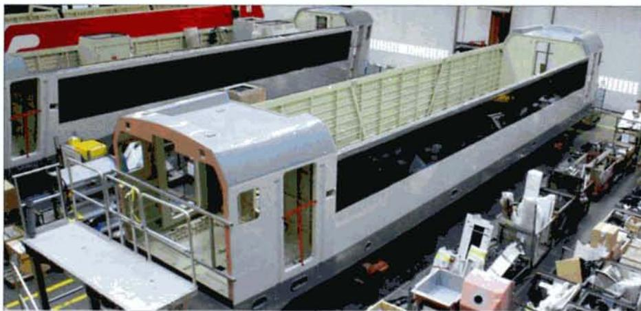
Montage du chaudron d'une 18. SIEMENS.
