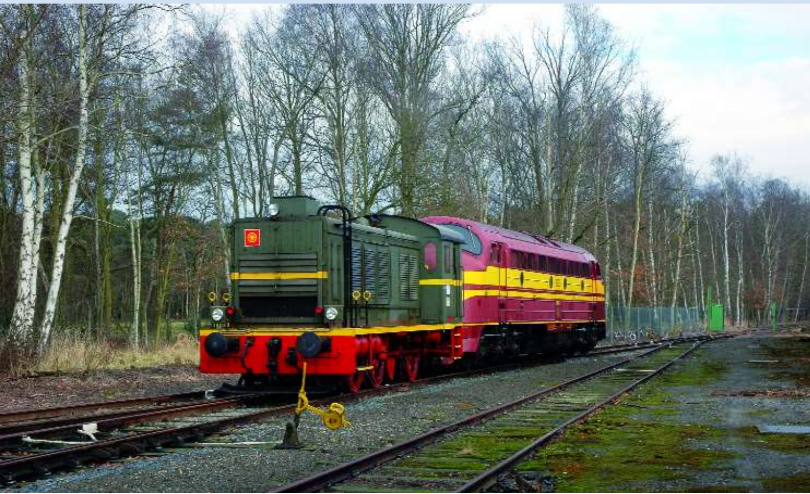
PHOTO 90-15 ↓ Une vue en plus gros plan. Par rapport à la photo de 1994 (page de gauche), elle a été modernisée par Locorem, reçu des nouveaux phares, une nouvelle bande jaune sur l'avant du capot et de la cabine, et a perdu une partie de ses inscriptions. PFT / Dave HABRAKEN.
