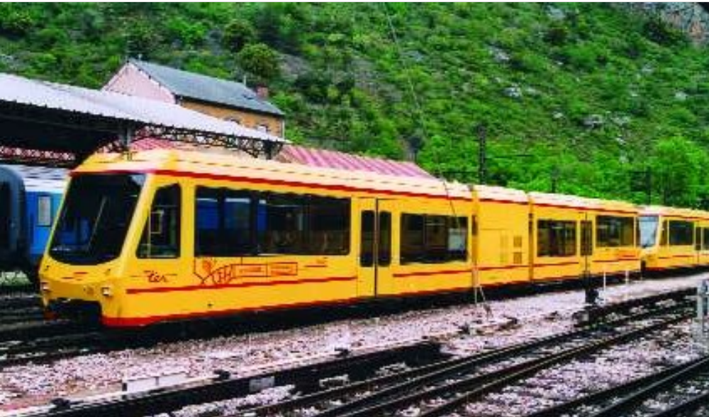
La ligne de Cerdagne Latour de Carol - Villefranche, exploitée par la SNCF et connue sous le nom de "Train Jaune", possède deux automotrices GTW alimentées par 3e rail. Les deux rames sont photographiées à Villefranche-de-Conflent, le 31 mai 2004. Tomas MEYER-EPPLER.
