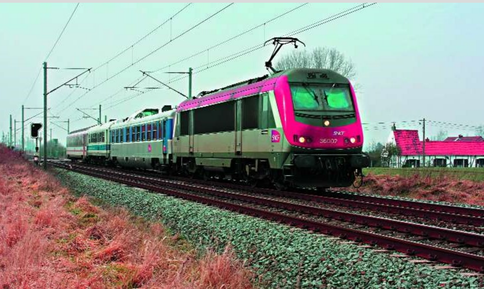
PHOTO 90-37 Le 4 février 2009, la SNCF a organisé des parcours de mesures au départ de Lille vers Tournai et Mouscron. La rame, composée des voitures IES143, Mauzin 211 et Fedora, était emmenée par la 36002. Passage à Blandain-Frontière lors du parcours vers Tournai. Le signal visible à gauche est le dernier du réseau SNCB, le suivant est un signal SNCF. Christian AUCQUIERE.
