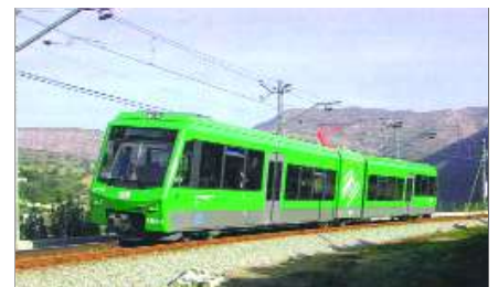
L'automotrice à crémaillère AM1 en service sur la ligne de Montserrat en Espagne. Photo STADLER.
