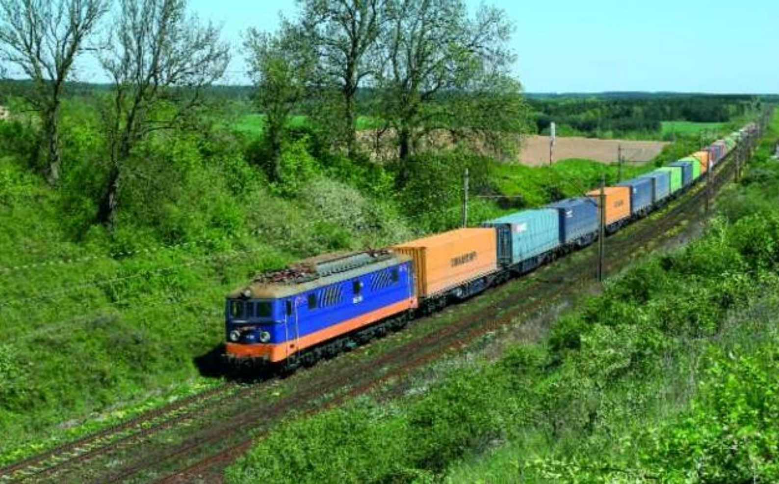
PHOTO 88-64 ↑ En Silésie, dans la région de Katowice, un gigantesque réseau minier utilisait une série de 68 locomotives électriques du type 3E, identiques aux ET21 des PKP (Co' Co' - PAFWAG 1957-1971 - 1860 kW - 120 t - voir EN LIGNES 77 page 9), où elles étaient utilisées à la remorque de trains de sable servant à combler les galeries abandonnées dans les mines de charbon. Après la suppression de ce réseau dans les années 1990, toutes ces machines furent acquises par plusieurs opérateurs et utilisées pour remorquer des trains sur le réseau polonais. PCC Rail Szczakowa (une des plus importantes sociétés privées polonaises) possède 18 machines de ce type. Le 9 mai 2008, la 3E30 passe à Terespol Pomerskie en tête d'un train de conteneurs en provenance de Gdansk. Jean-Luc VANDERHAEGEN.
