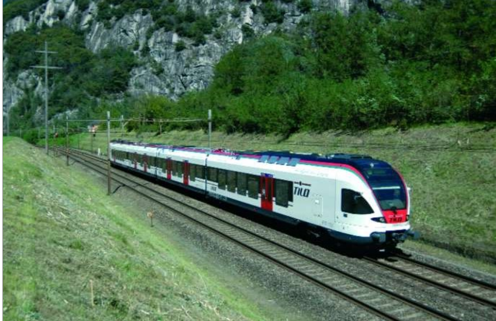
Les RABe 524 des CFF furent la première série de Flirt bitension (3 + 15 kV). Construites à 30 exemplaires, ces rames quadruples sont utilisées par la filiale TILO assurant les relations entre le Tessin et Milano. Claro, 8 septembre 2007. Marc STRIFFER.
