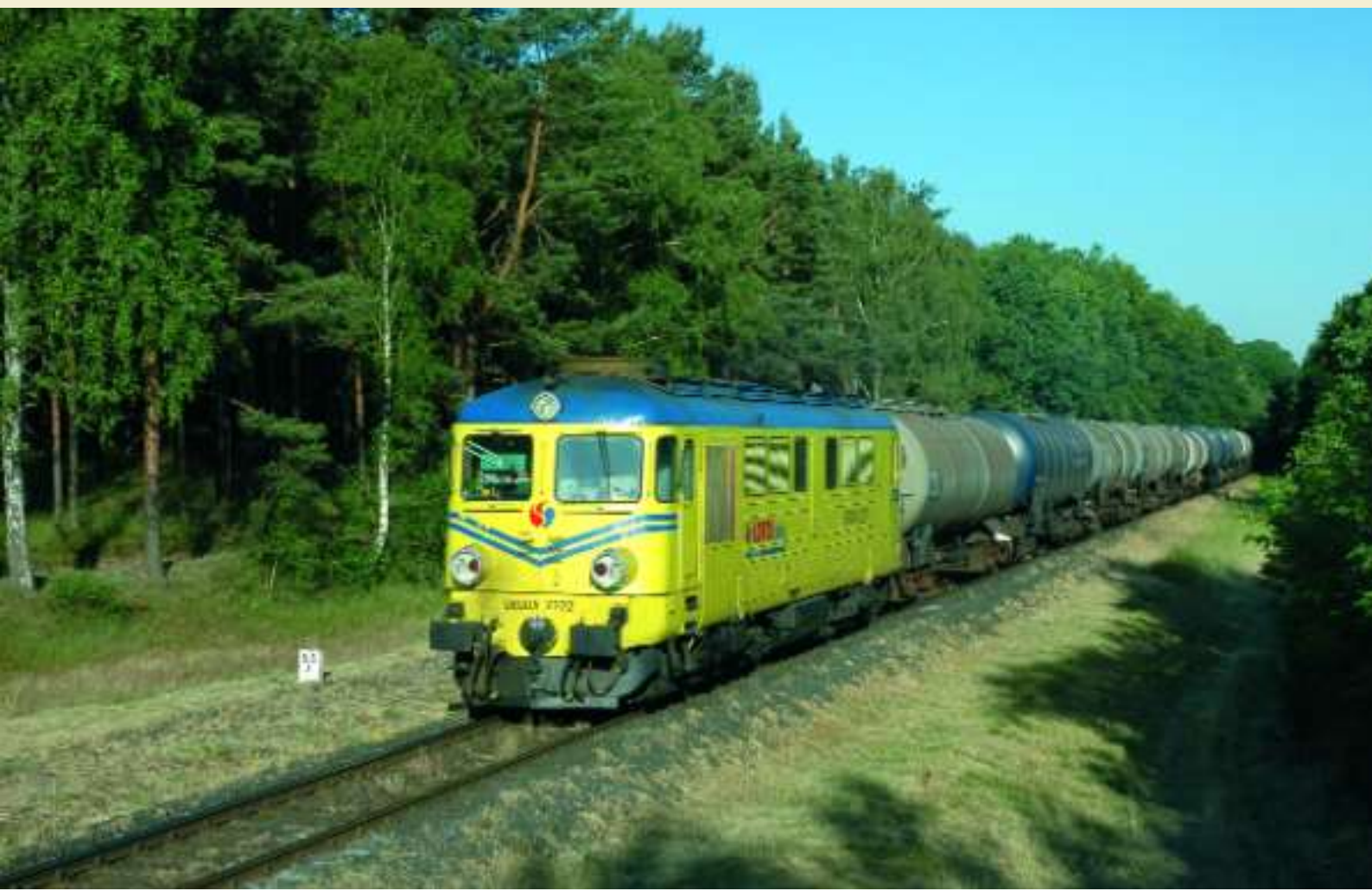
PHOTO 88-67 ↓ Plusieurs sociétés possèdent des locomotives Diesel du type 060DA (roumaines, identiques aux ST43 des PKP) acquises soit en Pologne, soit en Roumanie. Voici la 060DA2222 à Ciemnice, le 5 juin 2008. Ces machines ont été produites en Roumanie de 1960 à 1993 à 2496 exemplaires (Co' Co' - 1545 kW - moteur Diesel Sulzer - 116 t) pour les CFR (Chemins de fer roumains série 060DA, PKP série ST43, les BDZ (Chemins de fer bulgares) série 06, et la Chine (série ND2). Pierre HERBIET.
