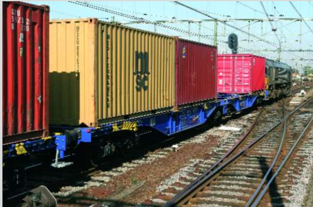
PHOTO 88-33 Le wagon porte-conteneurs double Sggmrss, numéro UIC 37 80 4961 461-3 D - DLC, à Roosendaal le 26 septembre 2008. Jean-Luc VANDERHAEGEN.
