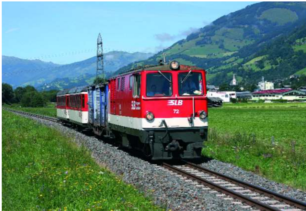
PHOTO 88-58 Le 10 août 2008, passage à Uttendorf-Stubachtal en direction de Zell am See d'un train composé d'un fourgon pour le transport de vélos et de deux voitures à bogies tractés par la Ds 72 (ex. ÖBB 2095 004). William BOECKX.
