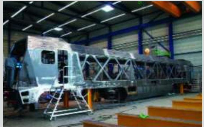
La caisse et le châssis ne forment qu'un seul bloc monocoque. Atelier Voith de Kiel-Nordhafen. VOITH.
