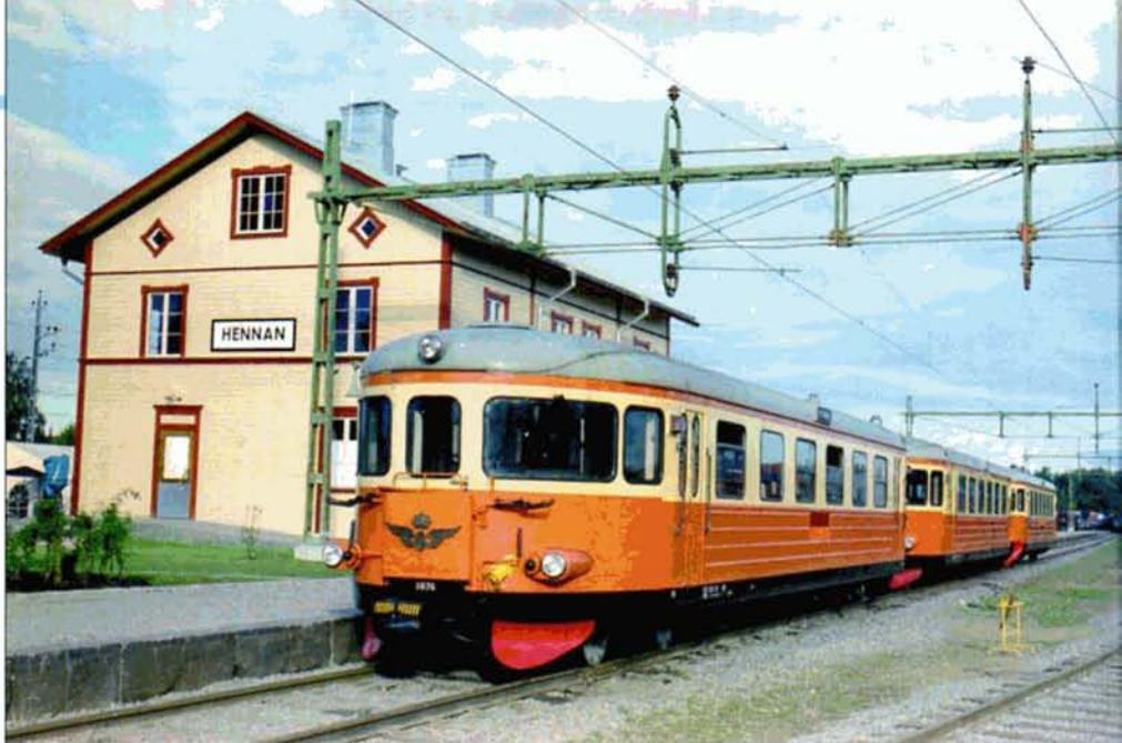
Arrivée à Hennan d'un train composé de trois autorails historiques mené par le Y8-1076. Plus de 150 autorails semblables furent mis en service de 1953 à 1968 par les Chemins de fer suédois (145 kW - 115 km/h, -19 t - transmission mécanique). Ils étaient répartis en trois sous-séries (Y6, Y7 et Y8). Il existait même des versions électriques (X16) et à voie étroite (YP), ainsi que des remorques avec ou sans cabine de conduite. Arno VEENHOF.
