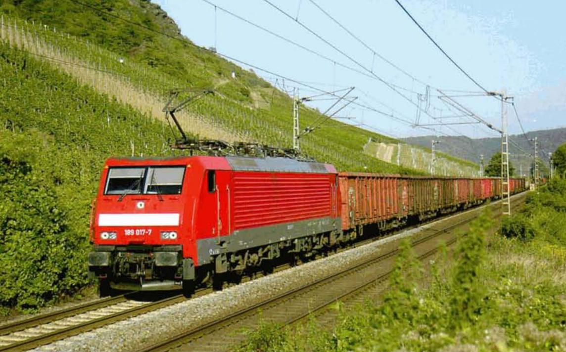
La 189 de Railion est une version quadricourant de l'EuroSprinter monocourant de la série 152. Elle se distingue de cette dernière en particulier par ses parois latérales nervurées. En effet, étant plus lourde, il a fallu réduire le poids en allégeant la caisse; les parois ont donc été renforcées par des nervures.
