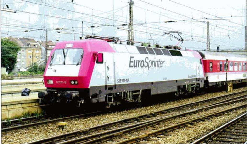
**PHOTO 78-69** L'*EuroSprinter* prototype - la 127 001 - testée par la DB en tête de l'EC 113 "Wörthensee" Dortmund - Klagenfurt, à Ulm Hbf le 14 août 1995. Elle sera acquise sous cette forme par les Chemins de fer espagnols, portugais et grecs. Christian VANHECK.
