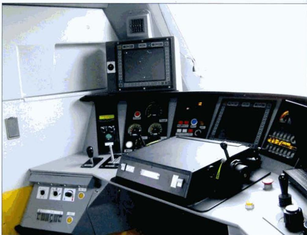
*Le pupitre de conduite des voitures-pilotes M6 est fort semblable à celui des locomotives de la série 13 et des voitures-pilotes I11. Grâce à la commande par multiplexage (MUX), l'utilisation des voitures-pilotes sera compatible avec les locomotives des séries 13, 18 (les 60 nouvelles EuroSprinter/Taurus commandées par la SNCB chez Siemens - voir page 23), et les 2721 à 2760 (ces dernières étant en cours de modification pour le fonctionnement en multiplexage).
