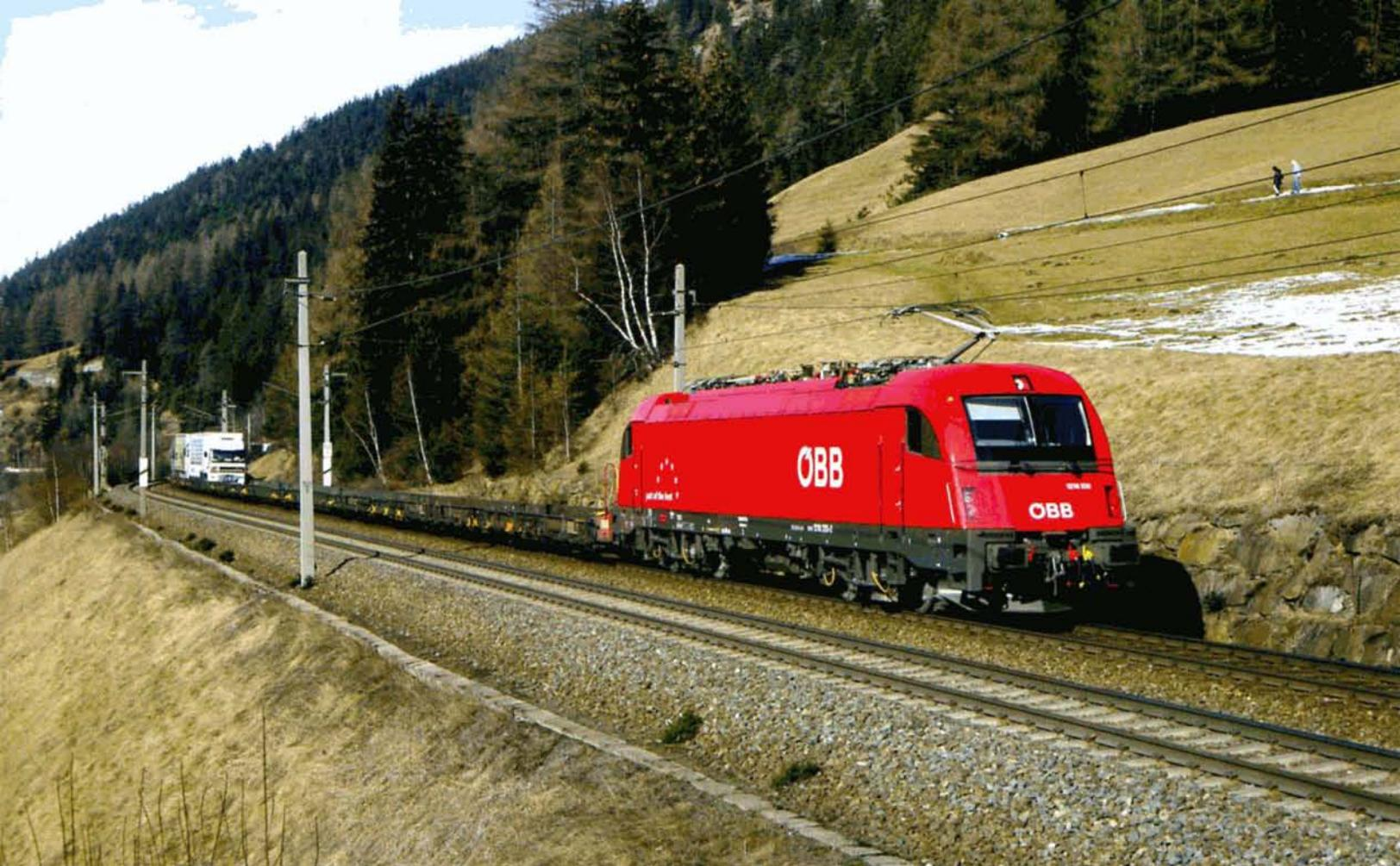
**PHOTO 78-71** Dès la sortie d'usine de la première Taurus, la plupart des experts et amateurs la considèrent comme étant une grande réussite esthétique. La 1216 235-2, une des 50 Taurus quadricourant des ÖBB, redescend la ligne du Brenner en queue d'un train de ferroutage "Rola" vers Innsbrück. La machine mise en service au début de l'année, ne circule que depuis quelques jours. Stafflach, 10 février 2007. Michel HANSENS.
