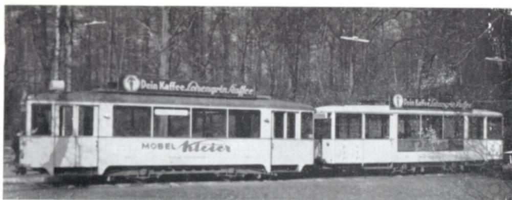
Motrice type « Aufbau » et remorque « K. S. W. ».
