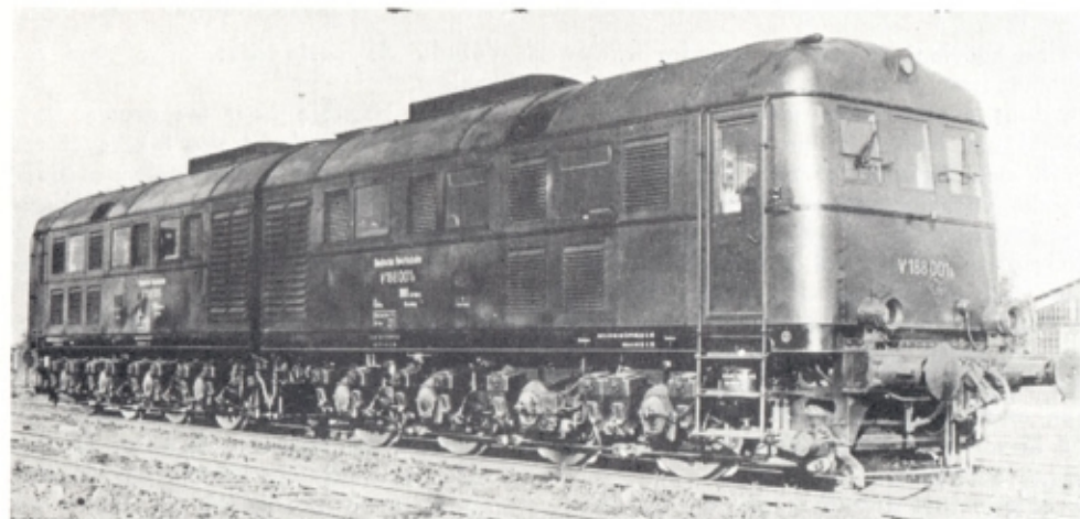
Locomotive diesel-électrique type V188 construite en 1941-42 pour la Wehrmacht — 2 x 940 CV — 75 km/h — 153 T. (Photo D.B.)
