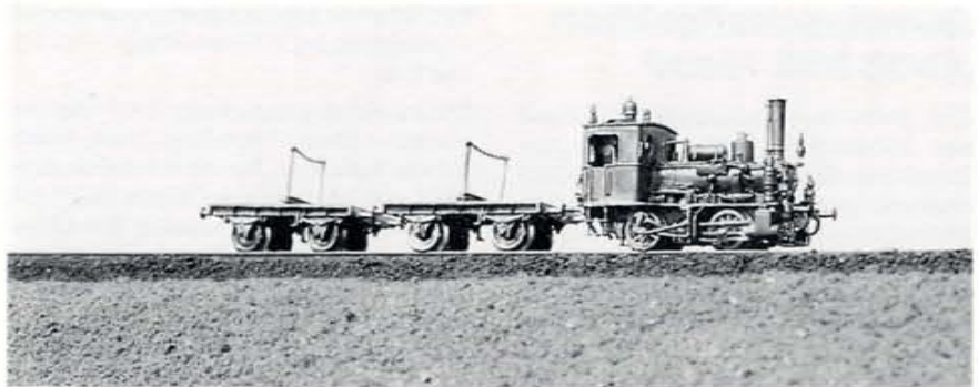
Die Railex-„Zugpackung“ (1015): D VI „CYBELE“ mit zwei H-Wagen der „Königlich Bayerischen Staatsbahn“. Alle Wagen werden mit einer Märklin-kompatiblen Kupplung ausgerüstet. Die dabei von Railex konstruierte Kupplungsaufhängung ermöglicht freie Durchsicht unter dem Wagenboden und hat zudem den Vorteil, daß die Kupplung unter der Achse gelagert werden kann.
