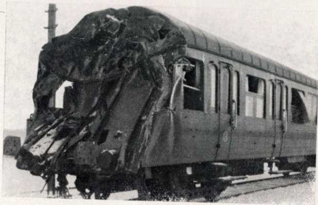
Photo 13 — Effet d'une collision sur une voiture métallique
