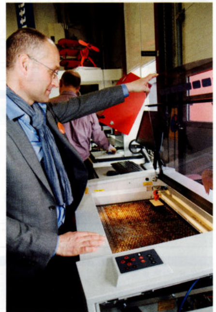
La vue 'sous le capot': on y voit la tête de découpe et la grille de travail sur laquelle repose le matériau à traiter. La découpe par laser est un processus par brûlage: le matériau est littéralement brûlé. Les résidus de cette combustion tombent à travers les ouvertures prévues dans la grille; c'est par là également que les fumées sont évacuées.
