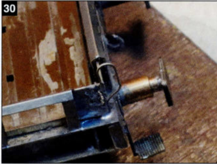
27. Les deux moitiés du crochet de traction doivent être pliés et soudés ensemble.
