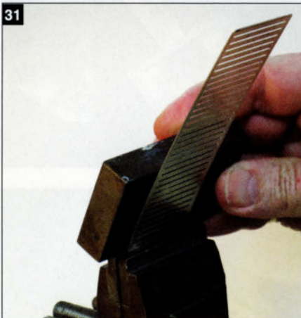
31. Nous plions d'abord les côtés courts du plancher à 90°, selon les lignes de pli gravées.
