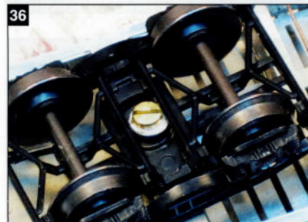
34. Pour la fixation des bogies, deux boulons M2 doivent être pourvus des rondelles nécessaires, que nous allons souder sur ces boulons.
