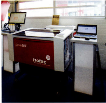
En fonction du Fab Lab choisi, plusieurs découpeuses au laser peuvent s'y trouver. Voici une Trotec Speedy, une machine apte à réaliser des travaux de découpe et de gravure exigeants.
