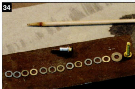
34. Pour la fixation des bogies, deux boulons M2 doivent être pourvus des rondelles nécessaires, que nous allons souder sur ces boulons.
