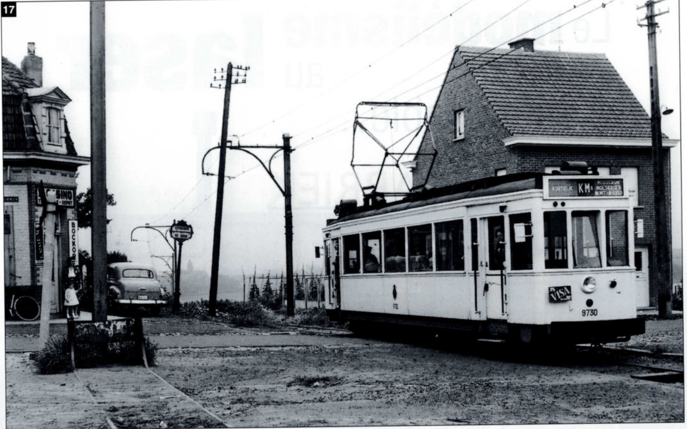
17. La motrice 9730 à Bellegem, le 5 juillet 1958. Pour le photographe, seul le tram comptait, mais pour nous, d'innombrables détails sont précieux, comme les types de mâts caténaires, le poteau 'Défense de circuler' et enfin, le heurtoir disposé au bout de la voie à marchandises (à gauche), derrière lequel un solide mât sert à fixer la caténaire (non visible sur la photo) (Document obtenu via Tramania).
