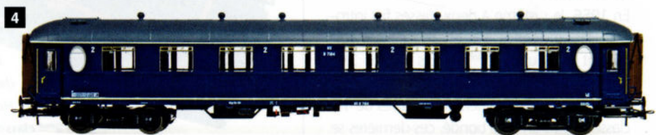
2. La voiture AB 7203 telle qu'elle fut utilisée entre 1947 et 1952. Elle est vue du côté 'compartiments': cela se voit immédiatement à la vitre ovale dépolie de la toilette et aux impostes de ventilation disposées au-dessus des grandes fenêtres. Les compartiments de 1 ère classe comptent encore quatre places assises.
