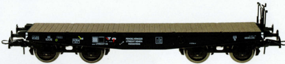
Le wagon 'SSy 45' à poutre en trapèze de Demka Hoogovens NS 92416, d'époque III, pourvu de bogies allemands.
