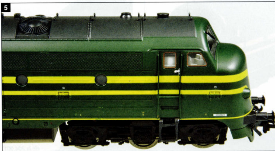
5. Une vue de détail d'un des bogies. Les blocs de frein ne sont hélas pas dans le prolongement des bandages de roues: en 2015, cela aurait pu être mieux!
