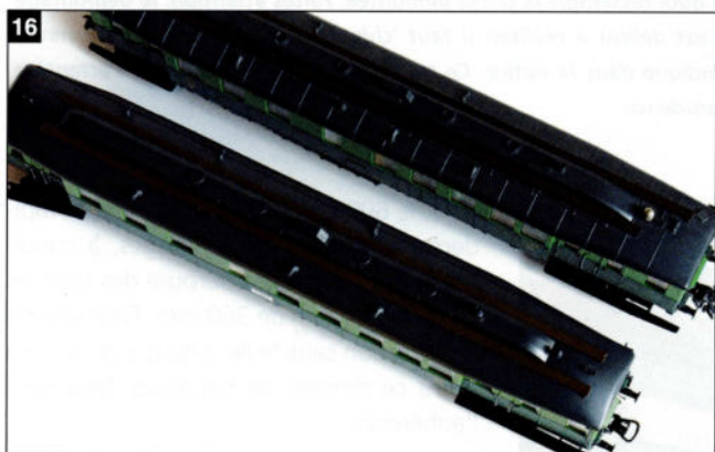
16. Le toit des deux modèles est clairement différent. Le modèle Märklin présente un toit nervuré, tandis que le toit Liliput est lisse. Sur base des photos existantes de l'engin réel, nous ne pouvons toutefois pas dire lequel des deux toits est le plus réaliste. Notez aussi que les pièces en toiture (dont les ventilateurs) sont séparés sur le modèle Liliput, et moulés dans la masse chez Märklin.
