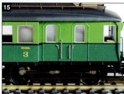
14. Sur le modèle Märklin, le châssis s'arrête à hauteur des bogies: c'était la solution technique nécessaire pour faire circuler ce modèle sur les courbes serrées de l'assortiment des voies Märklin.
