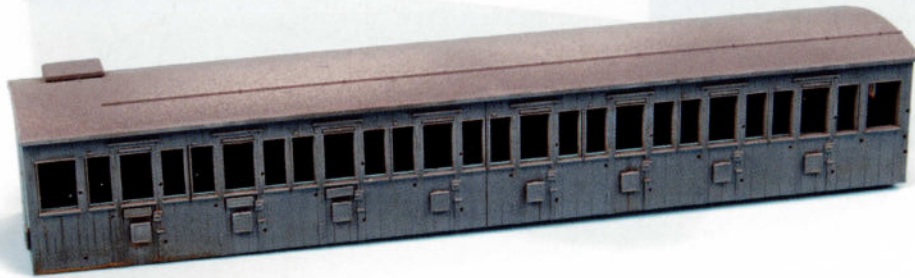
Démontons d'abord entièrement le modèle de la voiture GCI. Les vitres peuvent être facilement détachées, avec précaution. Lors du remontage, faites attention aux logements des étriers grâce auxquels la caisse est encliquetée au châssis. La caisse est ensuite peinte en gris moyen.
