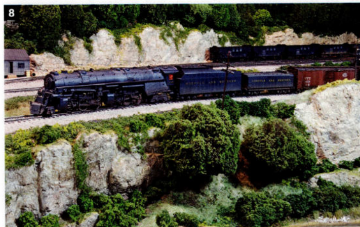
8. Grâce à leur châssis articulé, même les plus grosses locomotives – comme cette Class A 1217 du N&W – ne rencontrent aucun problème sur des courbes serrées.
