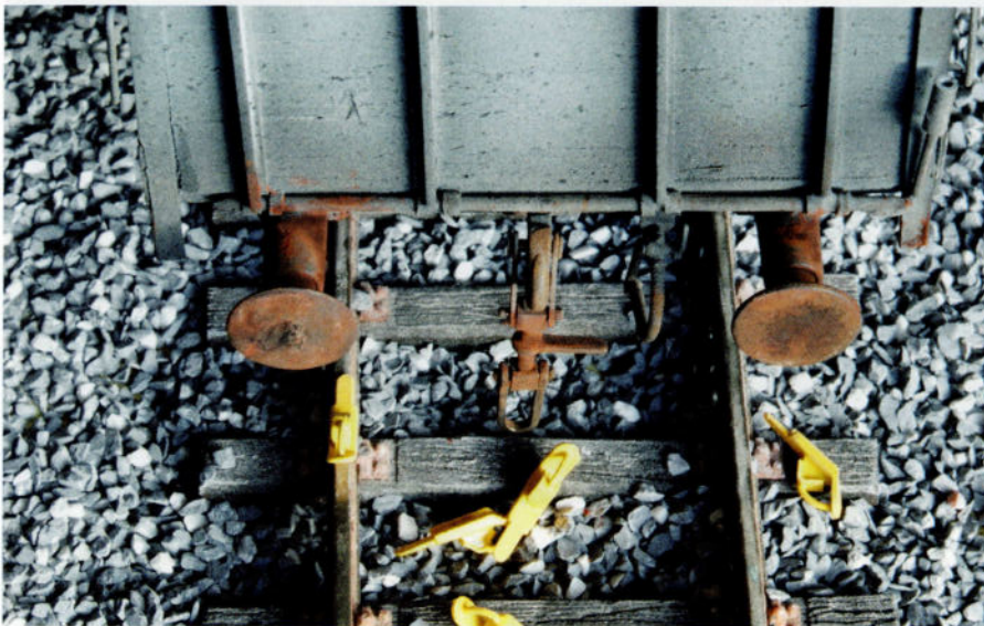
Détail de l'appareil de choc et de traction. Les tampons sont à ressorts et l'attelage à vis est réellement fonctionnel!
