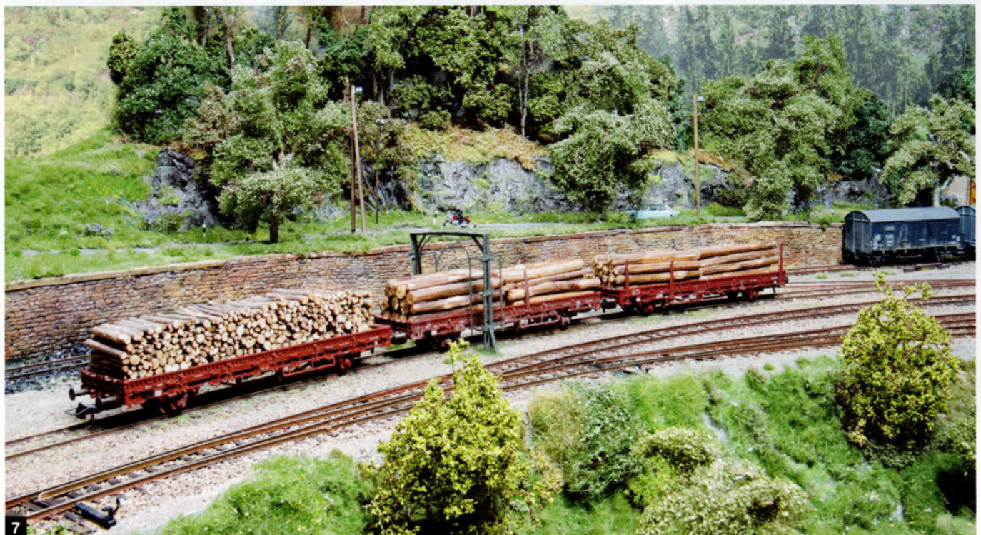
Pour le transport du bois, un gabarit sert pour vérifier si le chargement reste bien dans les limites du gabarit autorisé.
