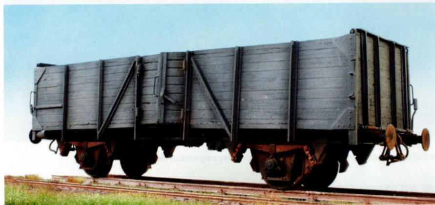
Le wagon à voie normale du type 'G' est prêt. Aux Pays-Bas, ces tombereaux ont été généralement utilisés pour le transport de charbon. Au retour vers la mine, ils étaient alors chargés de bois de mine.
