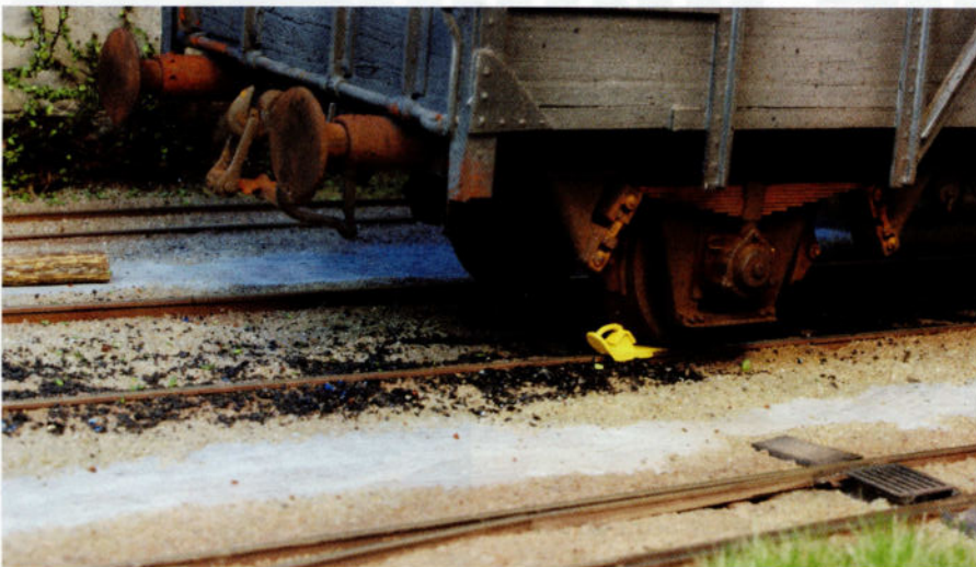
Le wagon est immobilisé au moyen de patins de frein de la marque Dingle.
