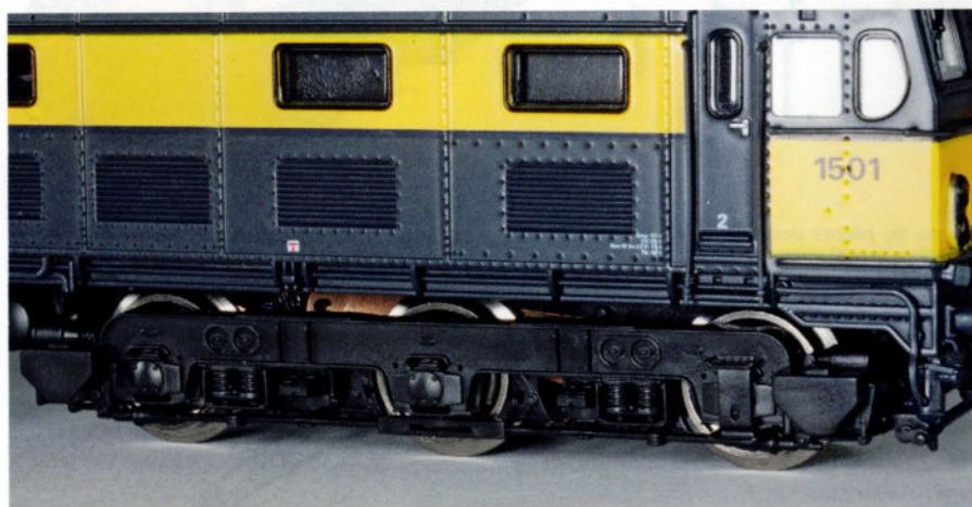
Deux essieux de chaque bogie sont moteurs, mais la prise de courant se réalise par toutes les roues.
