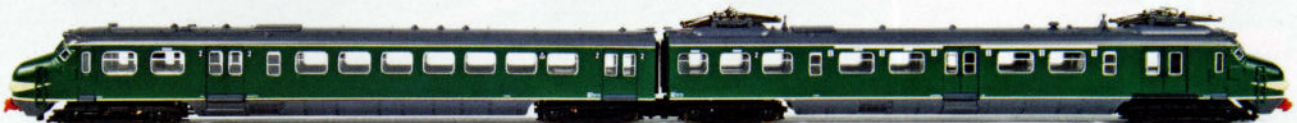
Ces voitures sont attelées de façon particulièrement serrée et logiquement pourvues d'un mécanisme à attelage court. La prise (à six pôles) pour liaison entre les deux caisses est à peine visible. Pour accoupler deux rames, une barre livrée conjointement remplace les coupleurs Scharfenberg.
