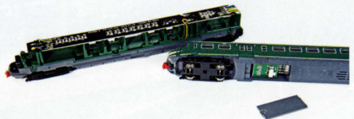
Le moteur est disposé très bas dans la caisse, caché de l'extérieur. Sous la caisse, on trouve un petit clapet derrière lequel se trouve le connecteur pour décodeur, ainsi que l'interrupteur pour l'éclairage intérieur.
