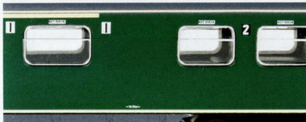
Le marquage est lisible à la loupe: type de voiture et matricule, poids, longueur, date de révision, etc. Toutes ces données sont reprises sur les caisses.
