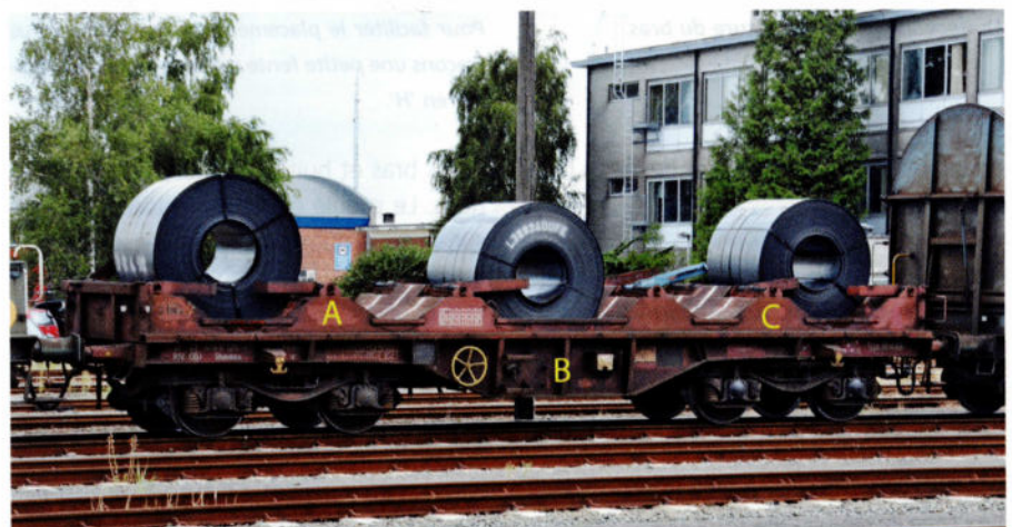
Ce wagon 31 88 476 6 126-7 est chargé de trois coils; sur le 2e, on peut voir un numéro de fabrication avec l'abréviation 'DUFE' (pour Dufenco). Ce wagon est pourvu d'un frein à main latéral. Port d'Anvers (faisceau 'Usland'), le 27 août 2009. Photo: Bart Luyten.
