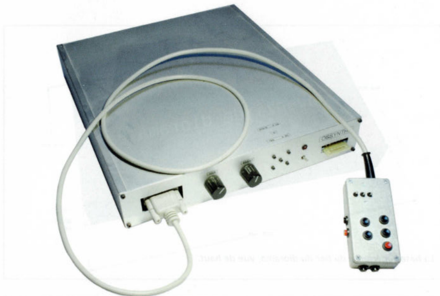
L'Ossynths, le synthétiseur d'Otto Schouwstra, pour sons de diesels synchronisés via un simple régulateur à main.
