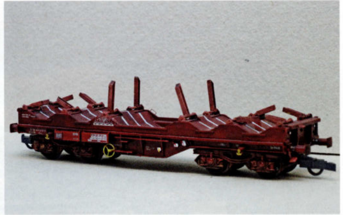
Les bras de fixation sont fixés à la colle instantanée; remarquez aussi la main courante de 0,2 mm.
