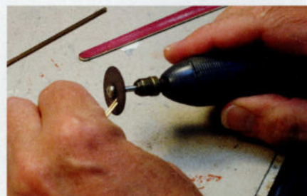
Vue du haut du bras de fixation. Avant de mettre ce bras à bonne mesure, nous l'amincissons en oblique selon un angle de 45°.
