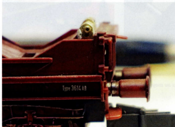
Les supports aux angles doivent être limés en partie basse, comme en réalité.
