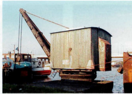
Cette grue avec flèche massive métallique et cabine en bois constitue un exemple idéal pour être reproduit en modèle. Cette grue est un témoin silencieux d'une activité ancienne et révolue. Comment ce témoin pourra-t-il être préservé d'une possible démolition?
