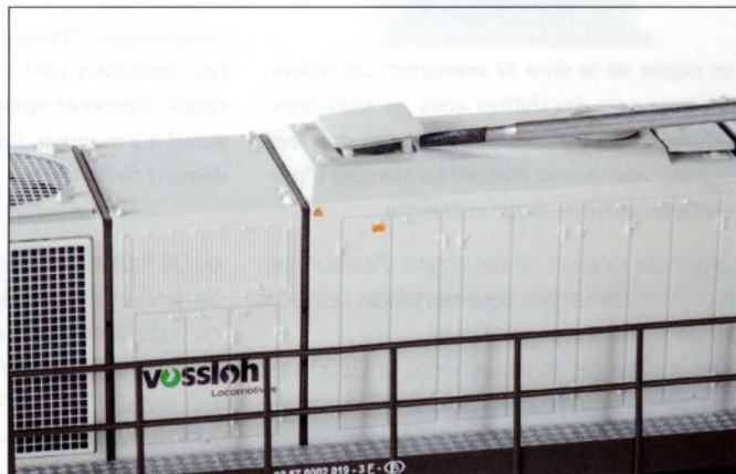
Sous un petit clapet, on trouve une petite vis qui permet de déposer la caisse. Utilisez pour ce faire un fin tournevis.
