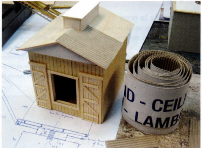
Du carton ondulé est collé sur les parties obliques de la toiture. Pour ce faire, du matériel d'emballage sous forme de carton ondulé conviendra bien. Ce matériel est facile à trouver en différentes tailles de structure ondulée et peut être utilisé pour plusieurs échelles. Après recouvrement d'une peinture à l'huile (Humbrol de teinte alu), on obtient une imitation parfaite d'une tôle ondulée métallique.
