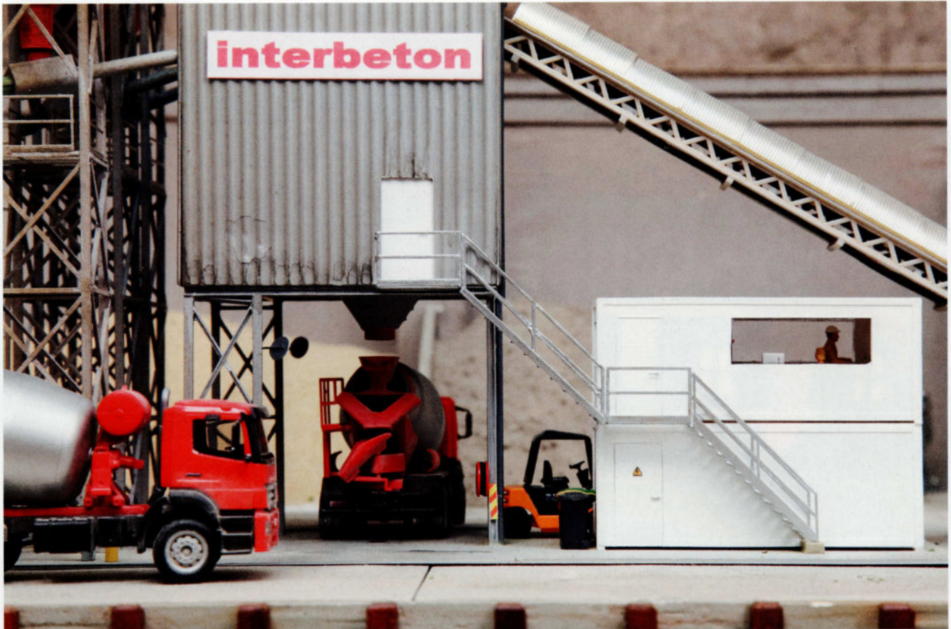
Un camion-toupie est rempli sous le mélangeur.
