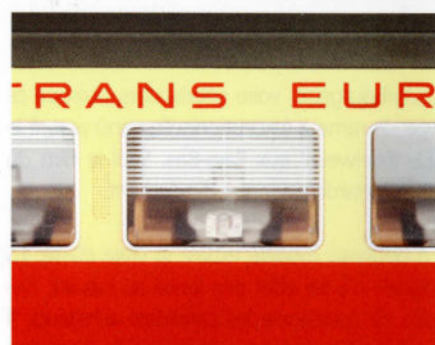
Les stores sont disposés entre le double vitrage. Lorsque les lampes de chevet sont allumées, l'éclairage de la salle est automatiquement réduit en intensité.
