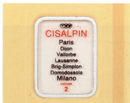
Les films d'itinéraire peuvent être modifiés au moyen d'une plaquette 'Iris' ou 'Edelweiss'. Ces films sont éclairés au moyen d'une Led.
