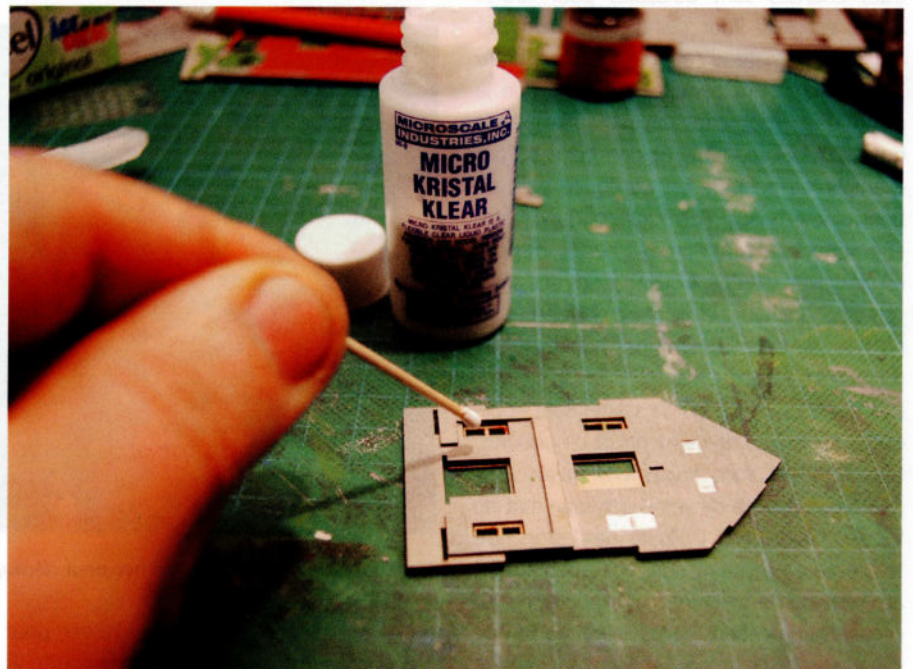
Les fenêtres sont réalisées avec du Micro Kristal Klear.
