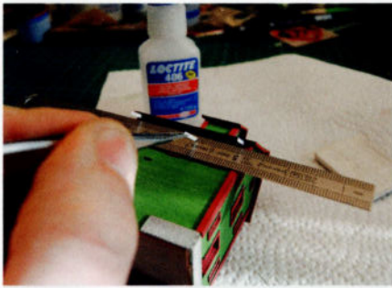
Les longerons du toit sont imités au moyen de tigettes de plasticard.
