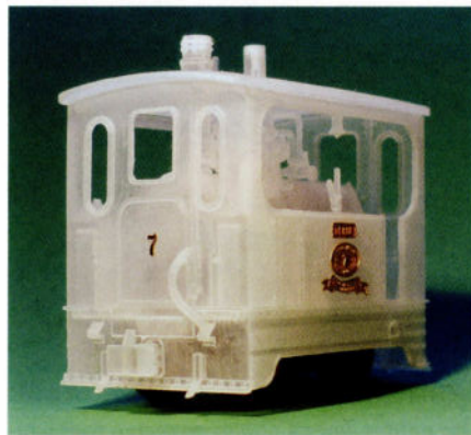
La toute première impression du tram à vapeur conçu 'maison'. Nous avons également essayé les petites plaques en laiton.
