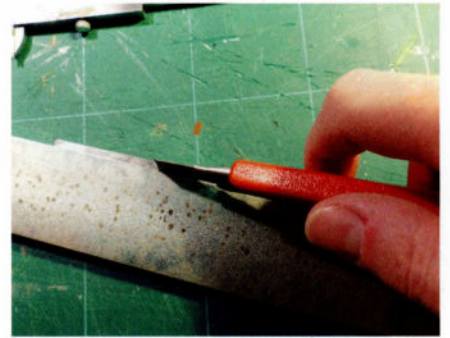
Le plomb est découpé à bonne mesure pour lester le modèle.
