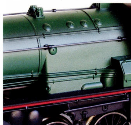
Détail de la chaudière. On remarque que les protections contre le gel ne sont pas posées, alors que c'était le cas sur la 26.038, d'après les photos disponibles.
