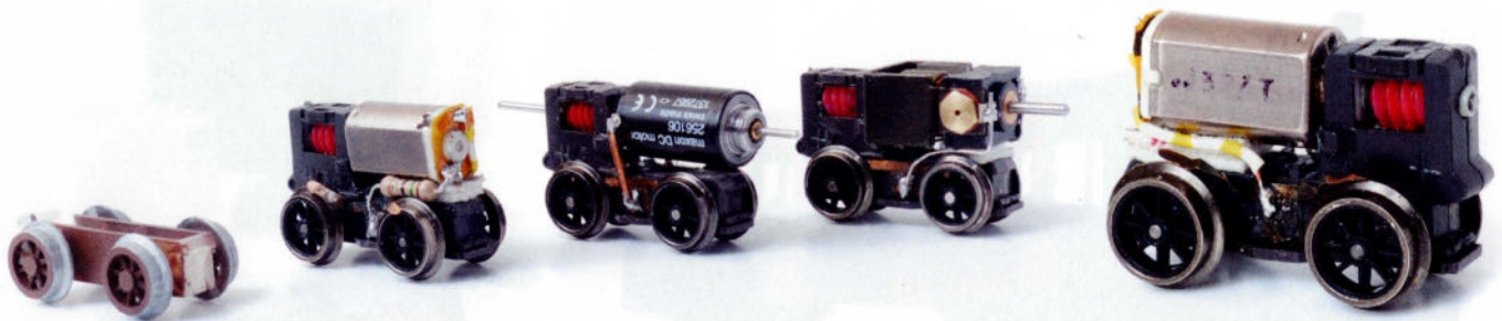
Un aperçu des essais entrepris avec un bogie Roco pour une BR 215. A gauche, une impression en 3D d'une locomotive-tramway non motorisée.
