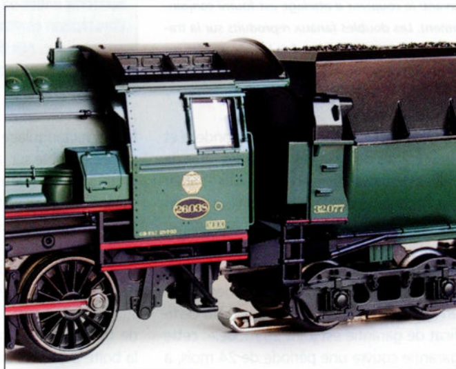
Les inscriptions sont jolies et complètes. La plaque de constructeur typique de l'usine AFB est clairement visible, même si elle ne correspond pas avec le véritable constructeur de cette loco: c'est la particularité de la 26.038. Remarquez aussi la lacune importante entre la loco et son tender.
