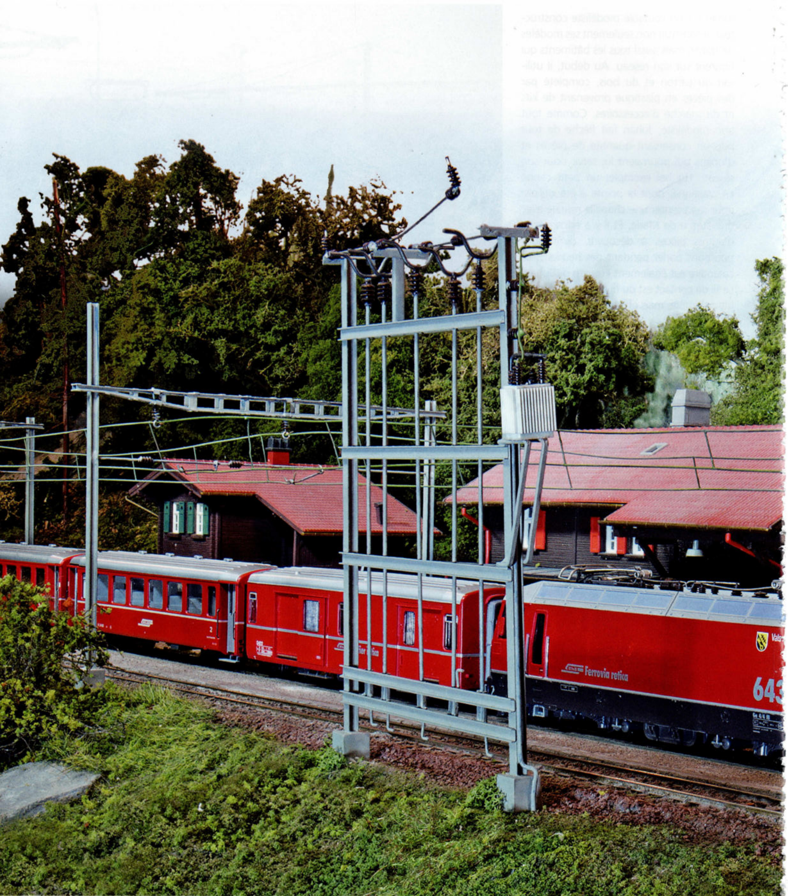
Des longs trains modernes circulent aussi sur les voies étroites de Suisse. 'Valdispere' a été conçu dans cette optique. Une image familière dans les gares suisses est le portique des interrupteurs d'alimentation des catenaires. Le modèle présent sur 'Valdispere' est issu de la gamme Sommerfeldt.
