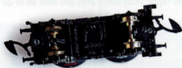
La différence entre des roues P:220 (à gauche) et des roues classiques en Z (à droite): les roues n'ont plus que 0,7 mm d'épaisseur et les flancs 0,2 mm. Il est flagrant que les attelages Märklin d'origine étaient bien trop grands: Brian les a remplacés par de jolis exemplaires de la marque MTL.
