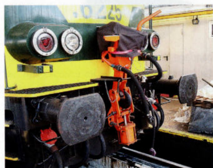
L'attelage semi-automatique de secours, vu en gros plan. Photo: Mark Hauer. Photo: Mark Hauer.
