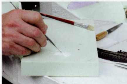
Pour combler les joints, une fine spatule est nécessaire, comme par exemple la tranche d'un tournevis. Plus pratique encore, cet outillage de dentiste.
