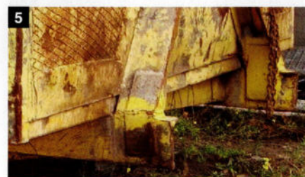
Les traverses de châssis en saillie.
