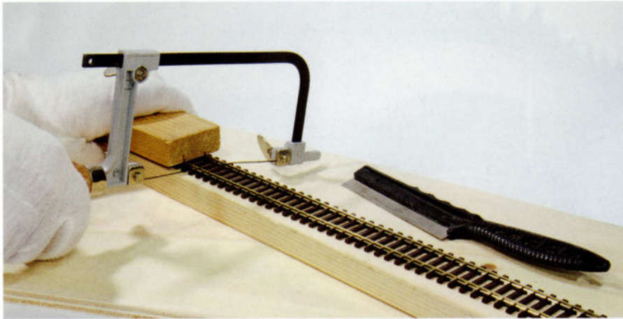
Lors de la découpe des rails, le risque existe d'endommager la petite ferrure. Pour éviter tout dommage, fixez toujours bien le rail. Un moyen d'aide précieux est un petit bloc avec deux sillons qui s'ajustent aux deux rails.
