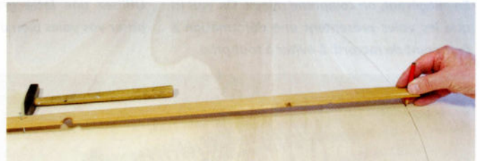
Un compas pour le dessin des courbes à grands rayons de courbure est vite fabriqué au moyen d'une latte, d'un crayon et d'un clou. Vous pourriez aussi dessiner la courbe au moyen d'une ficelle, mais il est d'abord très difficile de tendre constamment la ficelle et ensuite, il faut encore veiller à tenir votre crayon en permanence bien droit. A défaut, une différence de quelques cm est vite arrivée...
