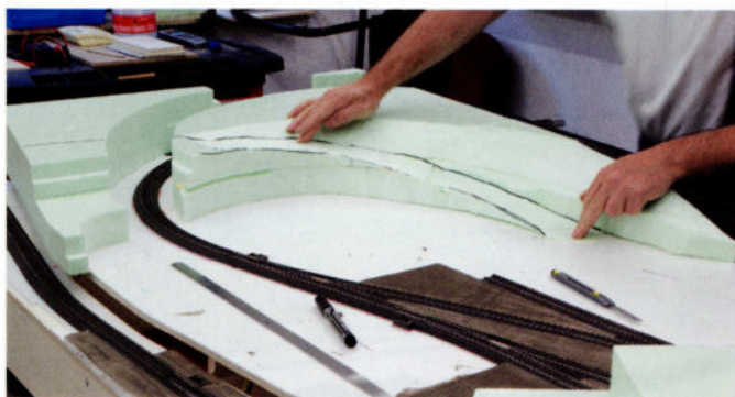
La rampe est découpée dans la plaque suivante de Styrodur, le long de la ligne qui vient d'être dessinée.
