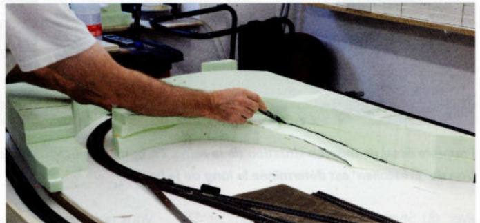
La rampe est découpée dans la plaque suivante de Styrodur, le long de la ligne qui vient d'être dessinée.
