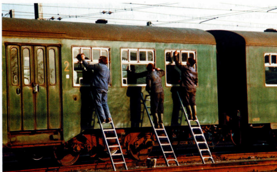
Les vitres des voitures M2 étaient encore lavées manuellement. Sous l'influence des intempéries, la toiture est redevenue noire de saleté. Photo: collection EVH.
