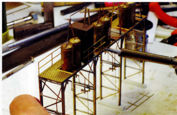
23. Les rambardes s'ajustent parfaitement dans les trous prévus dans la passerelle.
