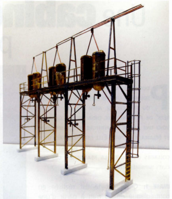
28. Détail des supports des conduites d'alimentation.
