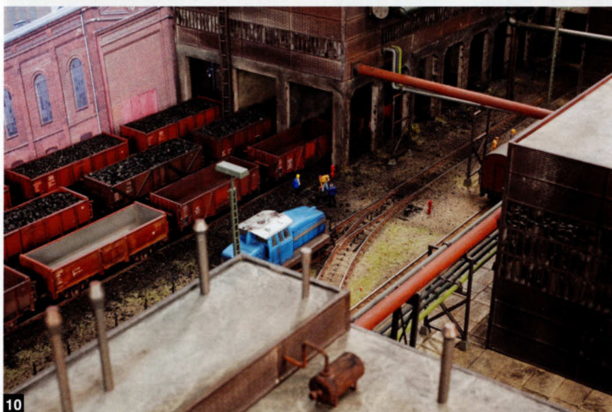
10. Au sein du complexe minier, les wagons sont poussés sous l'installation de lavage et de criblage. Après chargement, ils sont remorqués vers la voie d'échange par une locomotive Diesel moderne de la mine, de fabrication Henschel.
