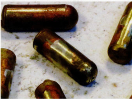
16. Les réservoirs de sable sont en laiton massif et doivent encore être quelque peu ponçés.
