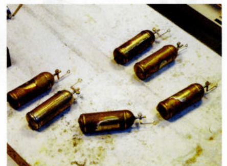
21. Les vannes sont fixées sous les réservoirs au moyen d'un petit bout de fil de 0,5 mm.
