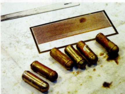
19. La pose des bandes de rivets sur les réservoirs, au moyen de colle instantanée.
