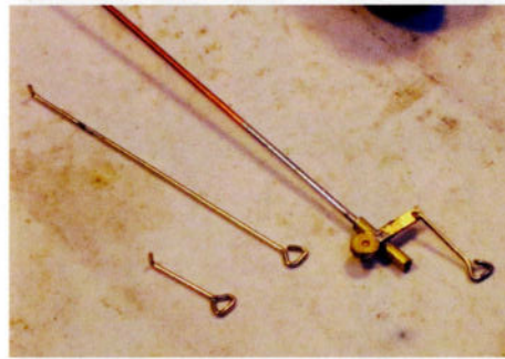
17. Des leviers courts au-dessus, des longs par-dessous : pliez-les dans du fil de 0,4 mm au moyen d'une fine pince.
