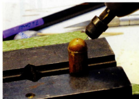
20. Le forage d'un trou supplémentaire (de 0,7 mm) pour un raccord ultérieur de la conduite inférieure. Il vaut mieux fixer le tout dans un étau.
