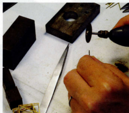
12. L'élimination des ébarbures sur les profilés.
