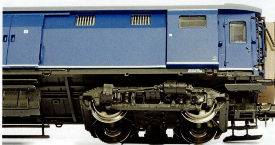
Lors de leur transformation en 1957/58, ces fourgons héritèrent de nouveaux bogies et de feux de fin de convoi électriques: des modifications que l'on retrouve sur le modèle Artitec, ainsi que la présence de la dynamo avec entraînement par l'essieu.
