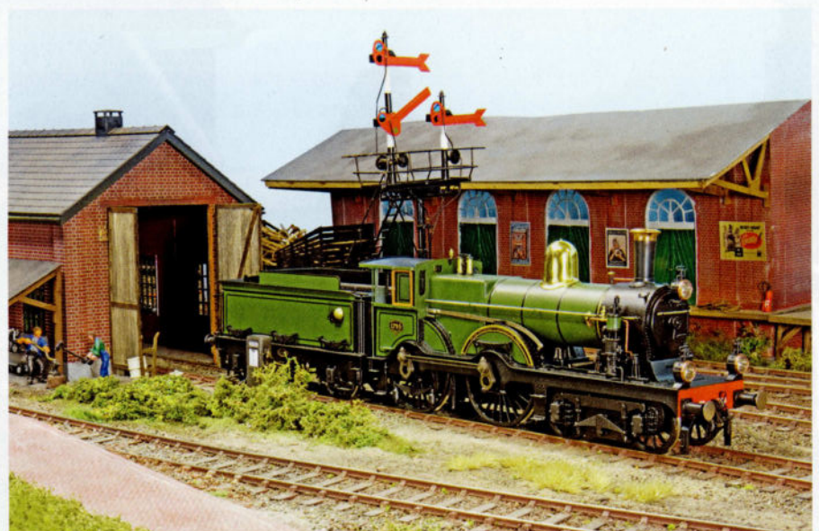
Une véritable perle présente sur ce réseau est la 1795 des NS reproduite par Philotrains. Edwin n'a pour une fois rien dû y transformer ni adapter. Comme déjà dit, le chandelier est disposé à un mauvais endroit. Il affiche de plus un aspect douteux: la palette d'avertissement indique que le signal suivant est au passage, alors que la palette d'arrêt est... à l'arrêt!
