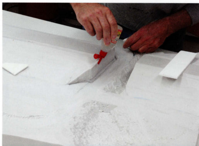
Les moulages découpés à mesure peuvent être fixés sur la base en mousse dure au moyen d'une colle-tout qui ne contient pas de produit dissolvant.
