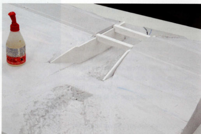
Dans la paroi, des encoches sont fraisées; les traverses du passage sous voies viendront s'y loger. Ce travail nécessite une certaine précision, à défaut de quoi le pont aura l'air de travers.
