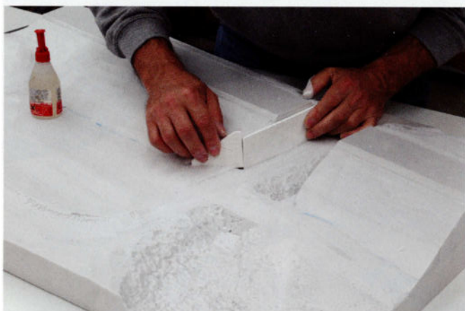
Les parois verticales du côté de la voûte sont travaillées à la lime, de façon à bien les ajuster.
