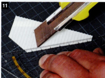
11. Avec finesse, même, si l'on prend soin d'effectuer des coupes à 45° par rapport à l'horizontale, permettant à une ligne de petits bois de se détacher visuellement. Ici, qui plus est, cette découpe inclinée est réalisée sur la partie oblique clôturant le pignon de la toiture.
