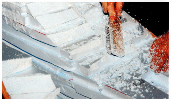
Le paysage est mis en forme au moyen d'une râpe et d'une brosse à poils en acier.
