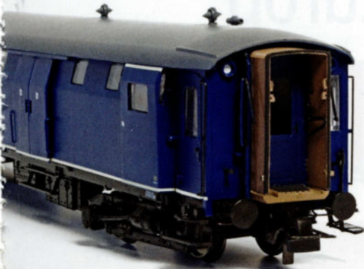
Un D en acier vu du côté plate-forme. On voit bien l'effet produit par les parois rétrécissant vers le haut de la caisse. Le soufflet d'intercirculation semble pourvu d'une suspension tant du côté intérieur qu'extérieur. Le fourgon réel reçut dès 1937 un soufflet de type 1935 sur lequel le mécanisme était entièrement suspendu à l'intérieur du soufflet, ceci en contradiction avec la suspension par trois points des soufflets du type 1954, sur lesquels la suspension était entièrement fixée à l'extérieur.
