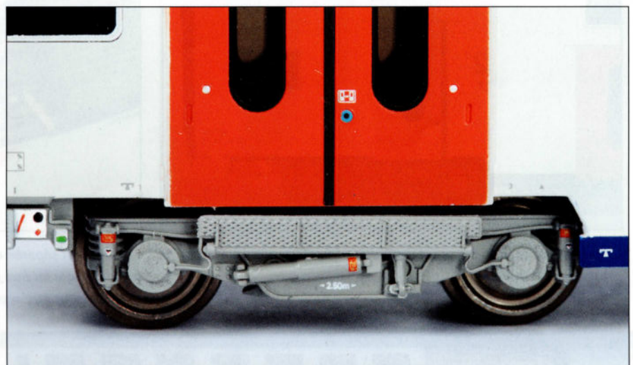
Chaque bogie a été reproduit comme en réalité. Ils sont pourvus de pièces supplémentaires et les couvercles des boîtes d'essieux diffèrent selon le type.
