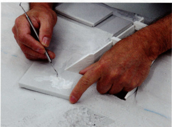
Nous préparons une petite quantité d'argile, car ce mélange sèche rapidement. Nous l'utilisons pour boucher les fentes dans les parois.
