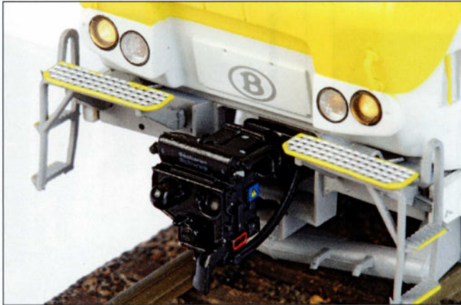
Le coupleur d'attelage GF peut être déposé et remplacé par un attelage classique. Le mode d'emploi joint au modèle vous explique comment pratiquer.
