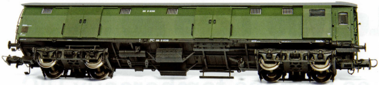
Le D 6315 d'Artitec. Parmi les nombreux détails visibles sous la traverse de caisse, on peut voir près du bogie de droite la dynamo entraînée par une poulie et une courroie en 'V'. Ce fourgon est posé sur des bogies prussiens provenant de voitures AB en bois.
