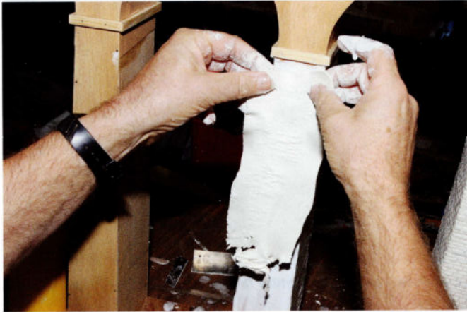
Une couche d'argile est plaquée contre la pile. Les bulles d'air sont explosées au moyen d'une aiguille.
