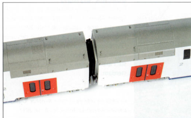
Le toit est gris foncé et renferme un groupe de climatisation à chaque extrémité, ainsi qu'un convertisseur statique à une extrémité et un réservoir à eau pour les sanitaires, à l'autre extrémité.
