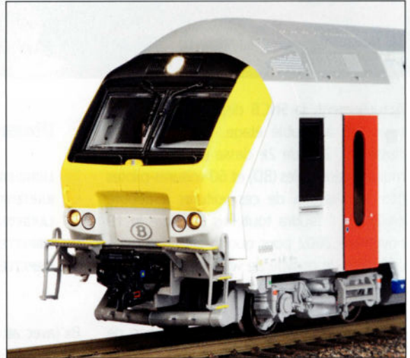
La seconde tranche des 19 voitures-pilotes commandées a été pourvue d'un attelage automatique GF, très bien reproduit sur le modèle.
