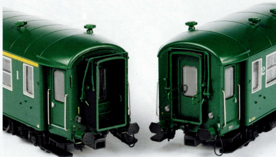
Les soufflets sont interchangeables: ils sont fixés par des clips à l'intérieur. Ils sont faciles à détacher au moyen d'un fin tournevis.
