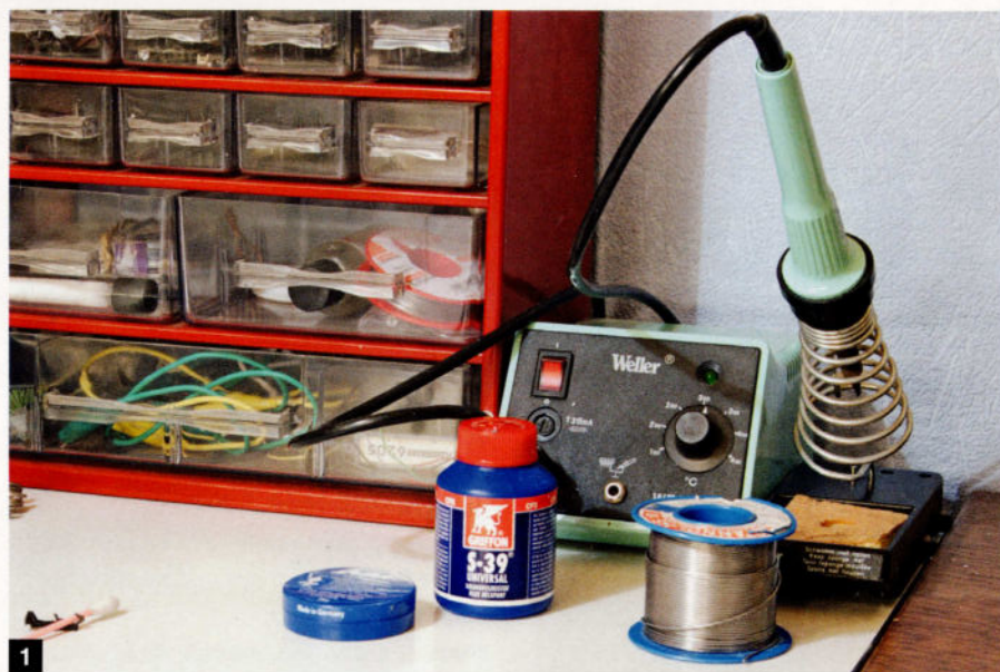
Photo 1: Les outils pour la soudure: une station de soudage, de l'étain pour souder et du flux (S-39 ou pâte à souder, disponible dans tout bon magasin de bricolage).
