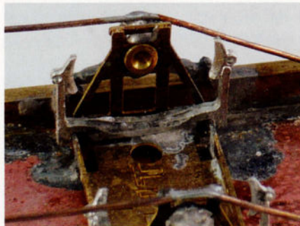
Une vue de détail de l'assemblage de l'essieu : des boîtes d'essieu en métal blanc et des blocs de frein.
