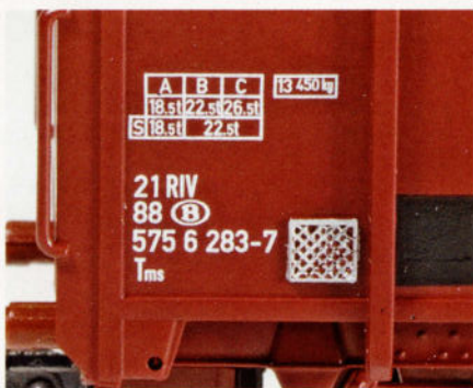
Détail du marquage sur un 'Tms' de Roco.
