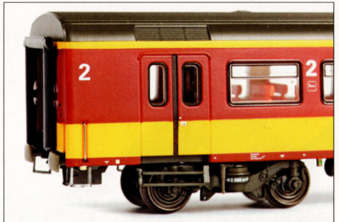
Les bogies sont particulièrement détaillés et portent la valeur de l'empattement. A l'arrière, on peut voir le marchepied avec main courante pour les agents de triage.
