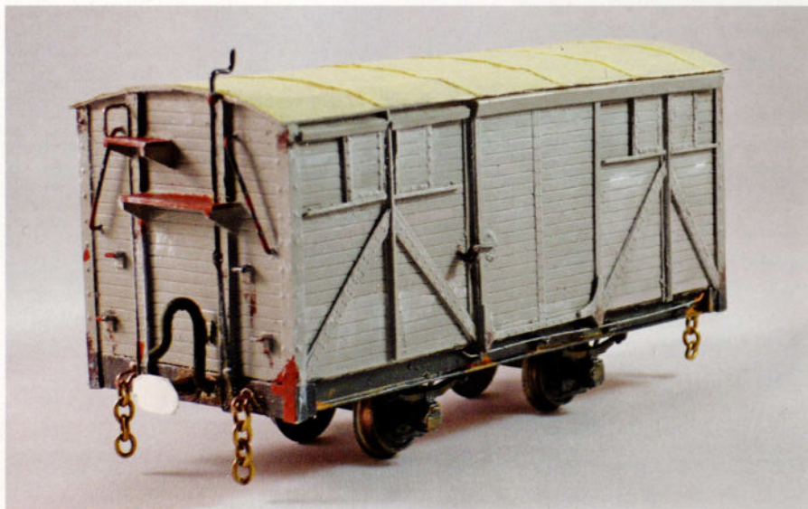
Notre wagon est quasi prêt. Le recouvrement du toit a été réalisé au moyen de papier adhésif.
