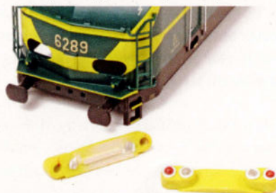
Les conduits lumineux découpés sont collés dans les supports de phares, après quoi le tout est proprement égalisé par ponçage.
