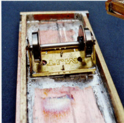
Une vue de détail de l'essieu suspendu.
