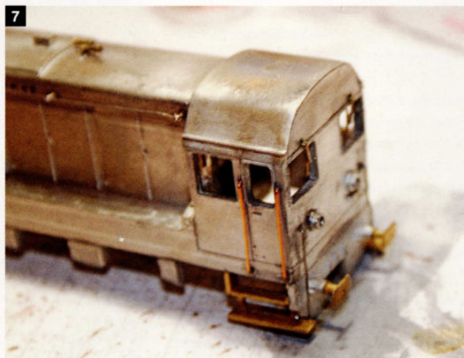
Photo 5, 6 & 7: L'assemblage de la caisse en métal blanc et des pièces en laiton.
