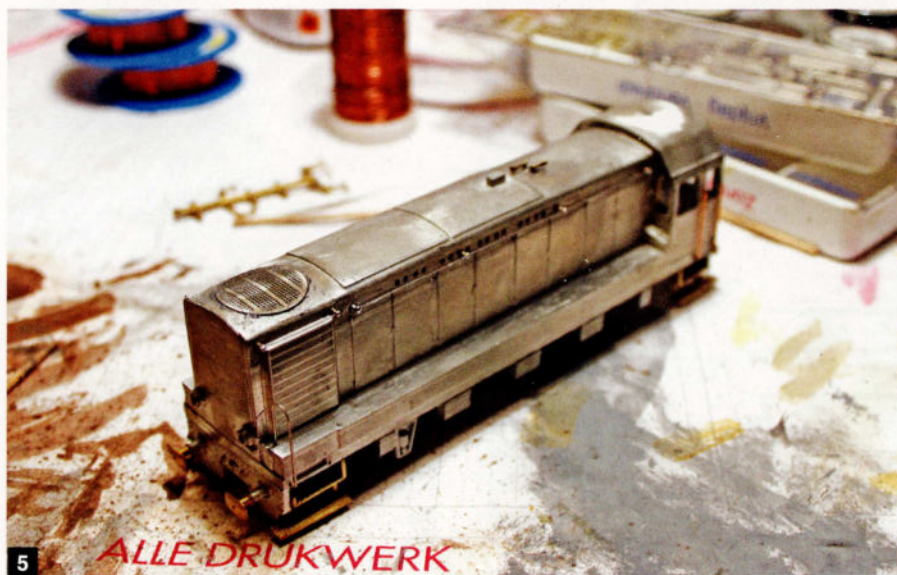
Photo 5, 6 & 7: L'assemblage de la caisse en métal blanc et des pièces en laiton.
