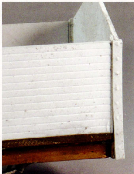
La bandelette imitant les rivets est collée sur la caisse de la voiture.
