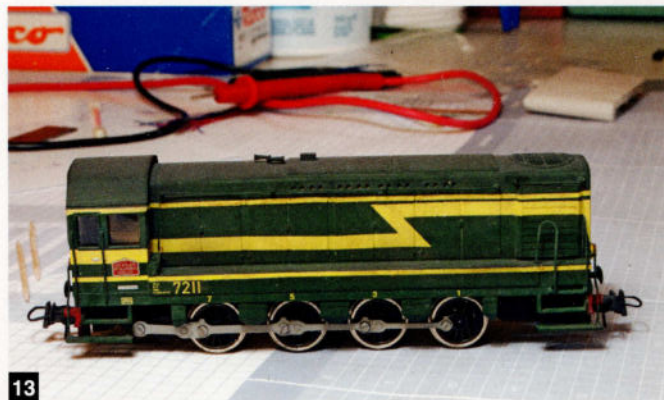
Photo 12, 13 & 14: Après l'application d'une couche de vernis destinée à protéger les décalques, la loco bénéficie d'une légère opération de patine.
