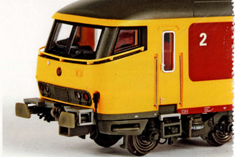
La voiture-pilote Benelux diffère de la version néerlandaise utilisée en service intérieur: elle présente une grille entre les phares et ses flancs comptent une fenêtre de moins.
