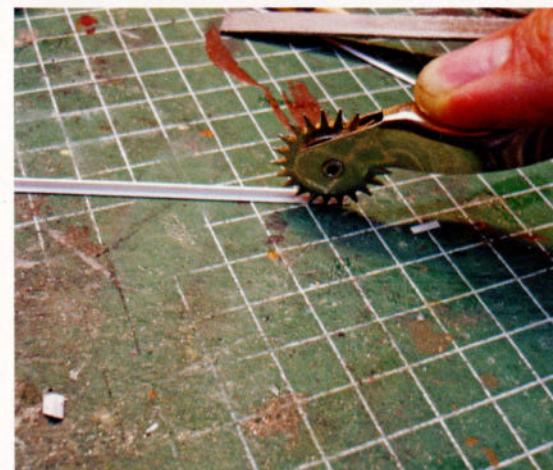
Les rivets sur une bandelette de plastocard sont réalisés au moyen d'une roulette dentée.
