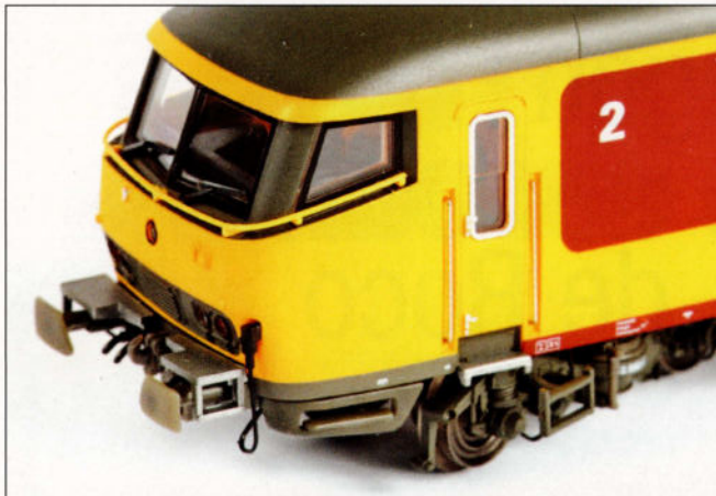
Le petit marchepied pour le conducteur est monté sur le bogie, ce qui permet la circulation du modèle sur des courbes serrées. Les grilles au-dessus des tampons sont en plastique.
