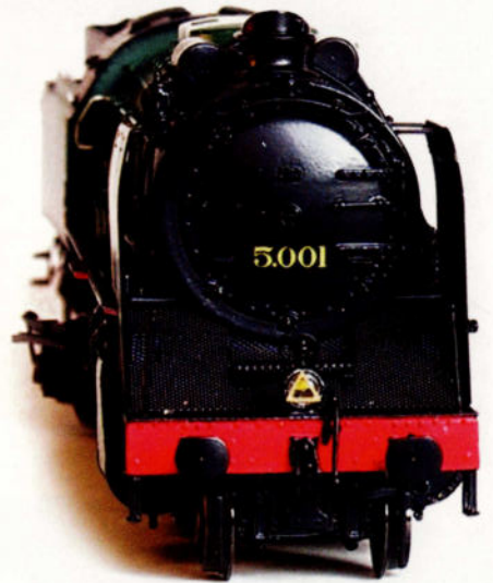
Vue avant de la 5.001. Remarquez la lanterne centrale sur la traverse de tête. On remarque sur la porte de la boîte à fumée le point de fixation pour la lanterne : cette dernière n'est pas présente sur ce modèle.
