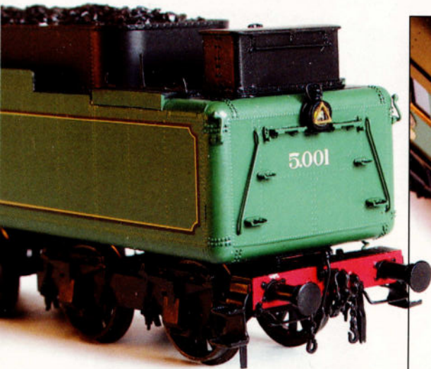
L'arrière du tender est particulièrement bien figuré. Cette loco est pourvue de série d'une imitation d'attelage à vis et pourvue de tous les équipements nécessaires à l'accouplement.
