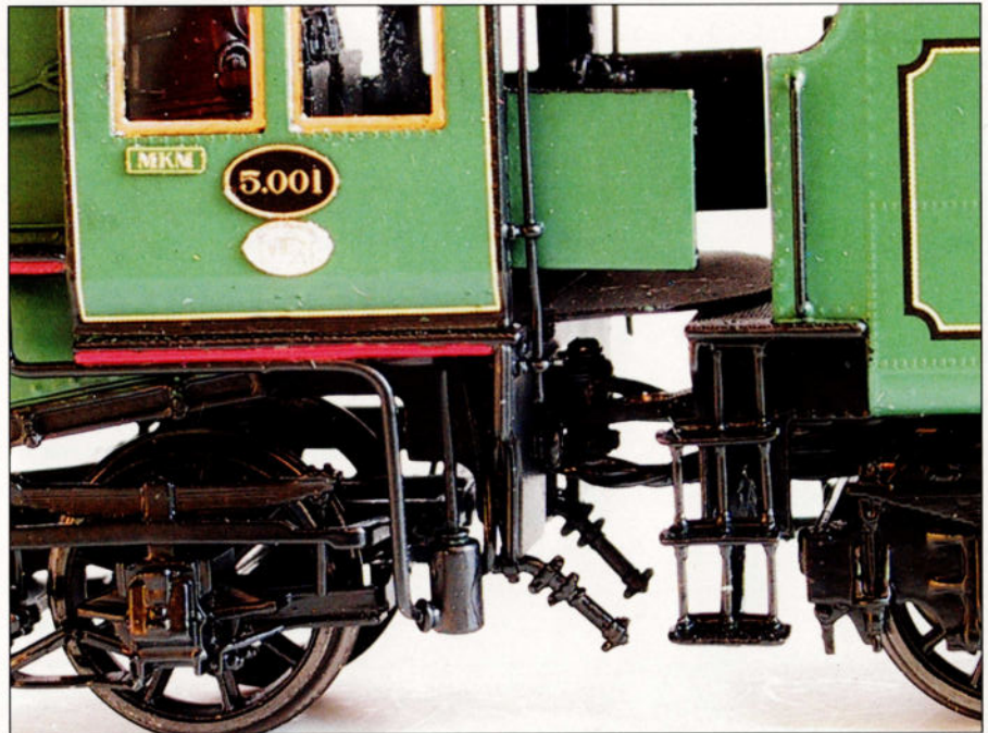
La loco et son tender sont accouplés de façon très réaliste : les fils électriques ne se remarquent pas. Le platelage entre la loco et le tender peut être relevé.
