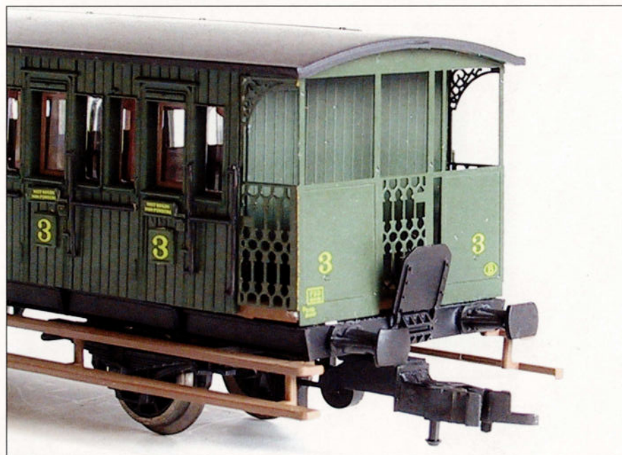
Sur la fine pièce en laiton gravé, on peut nettement voir la pliure : la plate-forme n'est en effet pliée qu'après que la bonne teinte lui ait été appliquée.
