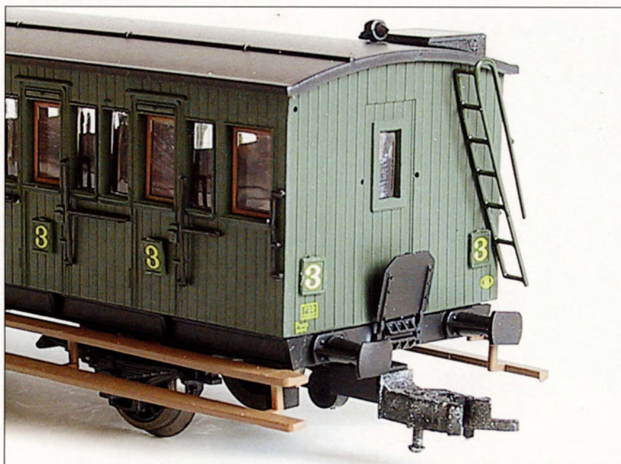
Une échelle a été montée sur la face d'about – côté toilettes – de la voiture sans plate-forme. Au-dessus de la toilette, un ventilateur est visible. Dans la face d'about, quelques trous préforés servent à y enficher des pièces supplémentaires.
