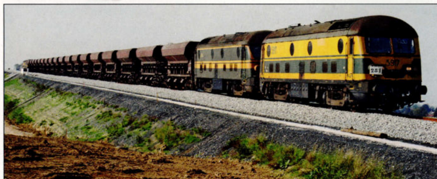
A la fin de leur carrière, les locomotives de la série 59 ont été utilisées pour la remorque de trains de ballast lors de la construction de lignes à grande vitesse. Voici une belle unité multiple des 5917 et 5946 à Sully (LGV 1), le 12 octobre 1996. Derrière le train se trouve un autre duo semblable.
