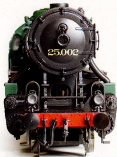
Une vue frontale de la 25.002 de Roco. Les fanaux de type allemand au-dessus des tampons devront être enlevés; par contre, la lanterne centrale est à la bonne place.
