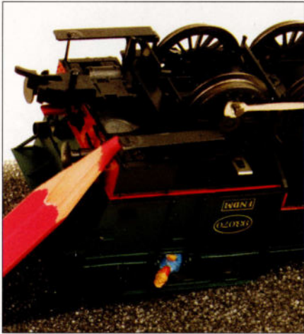
A l'arrière, les marchepieds pour manœuvres sont fixés d'un côté au marchepied existant.
