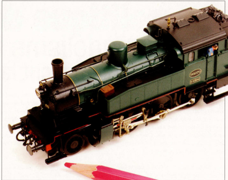
A l'avant, montage des deux petites tiges de laiton sur lesquelles le marchepied sera fixé. Remarquez aussi la nouvelle tôle où se trouvaient initialement les deux fanaux. Sur la soute à eau, une caisse à outillage a été installée.
