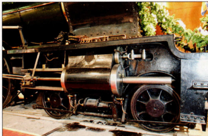
Modèle réel et modèle réduit: Des deux côtés de la loco se trouvent les graisseurs Wakefield, sur le tablier. Ils sont entraînés par un levier relié à un excentrique aux cylindres extérieurs. L'angle double de ce dernier tel que visible sur le modèle est une concession pour pouvoir circuler sur des courbes au rayon de 420 mm.
