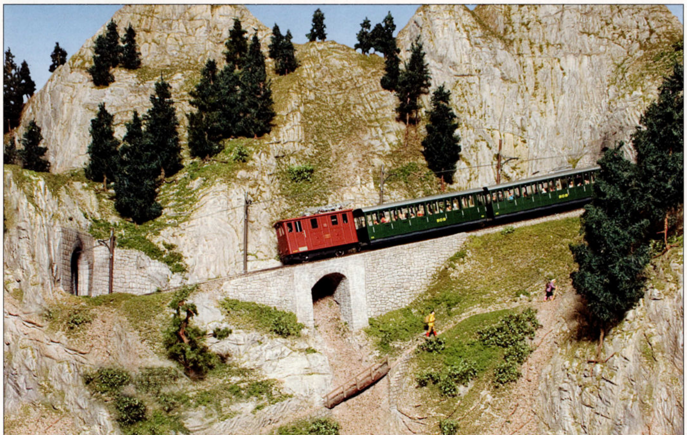
Nos convois miniatures sont capables d’avaloir de solides rampes; il est toutefois raisonnable de limiter les degrés d’inclinaison à 2,5% sur lignes principales et à 4% sur lignes secondaires. Si vous désirez des rampes plus fortes, faites comme en réalité: utilisez des locomotives spéciales, équipées le cas échéant d’une crémaillère, et limitez le nombre de wagons remorqués.
