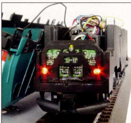
Les feux de fin de convoi sont disposés dans les blocs optiques extérieurs.
