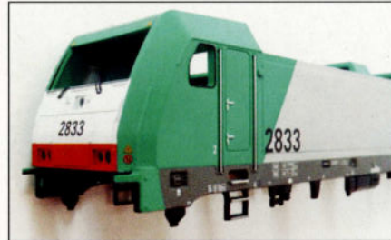
Les grands matricules sont placés sur les faces d'about et sur les flancs du modèle.
