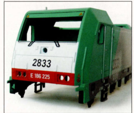
Les décalques sont fixés par une fine couche de vernis transparent.
