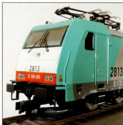
Gros plan de la face avant: on voit nettement que les lentilles des feux de route sont plus petites que les phares normaux.
