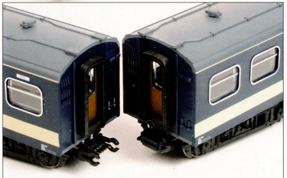
Les deux caisses sont reliées par un attelage fixe, conducteur de courant; la séparation des deux caisses requiert un peu de doigté.
