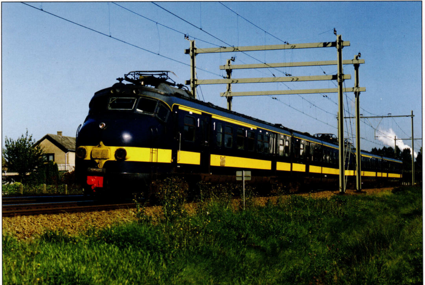
Deux automotrices Benelux en route de Roosendaal vers Anvers franchissent le 'sas' électrique de Roosendaal, pantos baissés.
