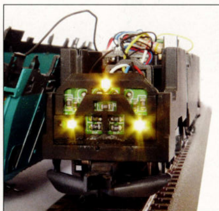
Les feux de route sont disposés dans les blocs optiques intérieurs.
