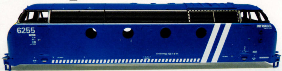
Photo 19: La dernière phase est l'application du vernis. J'ai utilisé du vernis acrylique transparent de marque Motip. Appliquez avec soin en plusieurs couches successives, de façon à ce que les décalques ne se froissent pas: ces dernières sont très fragiles et risquent de rapidement se boursoufler.
