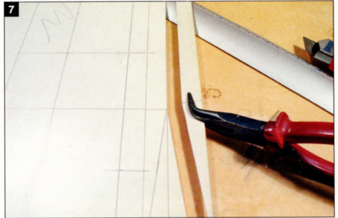
Photo 7. Une pince à becs recourbés vient à point pour plier et casser ce qui n'a pas été entaillé par le tranchet. Il est bon de plier progressivement la pièce à détacher en déplaçant les becs de la pince le long de la rainure.
