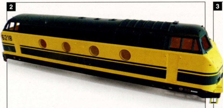
Photo 2: La caisse nue est prête à être passée au papier abrasif: c'est du grain 800, résistant à l'eau et mouillé pour l'opération.
