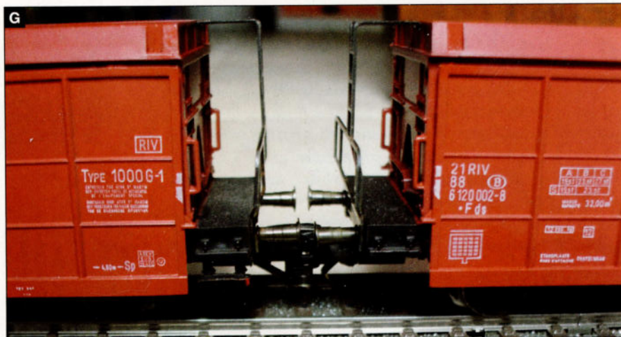
F. Détail du mécanisme d'attelage court, une fois monté.
