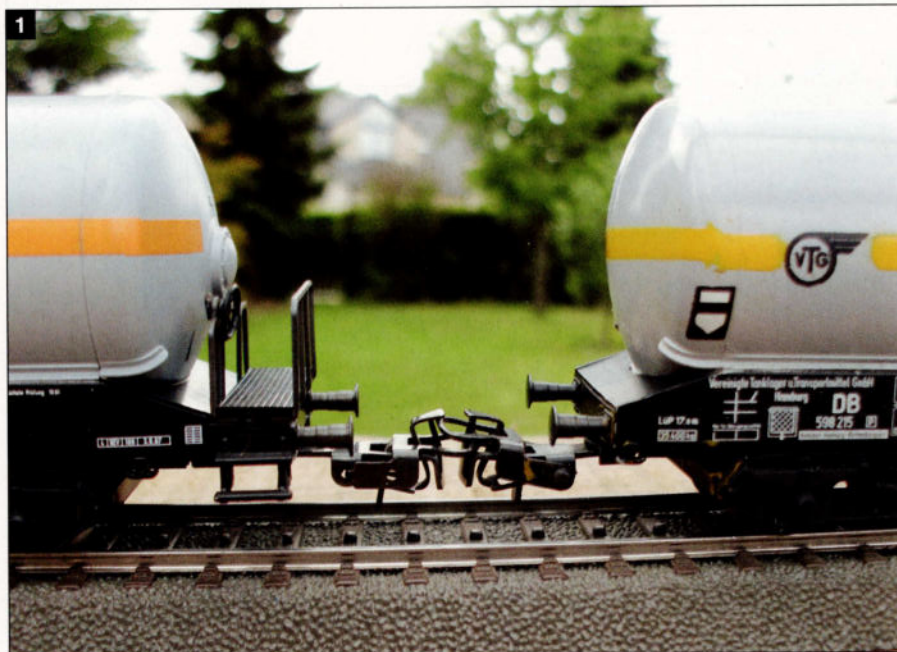
1. Avec les attelages standard normaux, l'espace entre deux wagons est presque de 2 cm.
