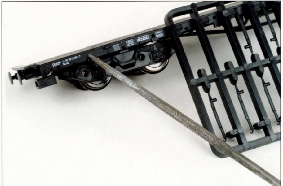
Au moyen d'une petite lime triangulaire, les trous prévus pour les ranchers peuvent être ajustés. Les ranchers attachés sur leur arbre de moulage doivent être découpés. Si un 'accident' devait survenir, un jeu de ranchers de réserve est prévu.
