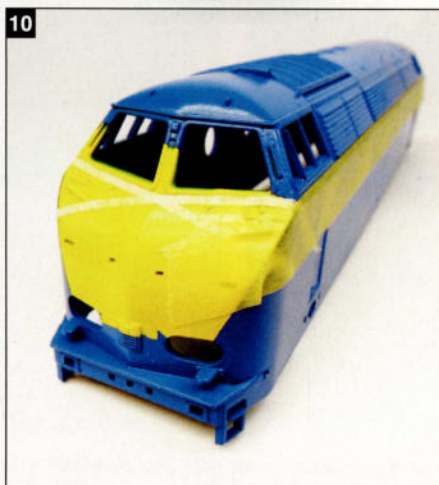
Photo 8: La caisse a reçu sa teinte bleue, à savoir de la RAL 5005, à laquelle j'ai ajouté quelques gouttes de blanc.
