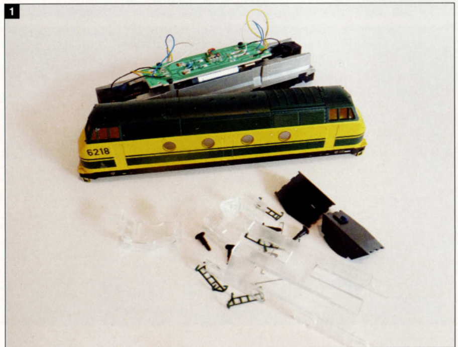
Photo 1: Premièrement, il faut démonter complètement notre Roco. Après que la caisse ait été séparée du châssis, toutes les pièces peuvent alors être détachées avec précaution. Heureusement qu'aucune colle n'a été utilisée pour le montage de cette loco et que tout peut donc facilement être détaché.
