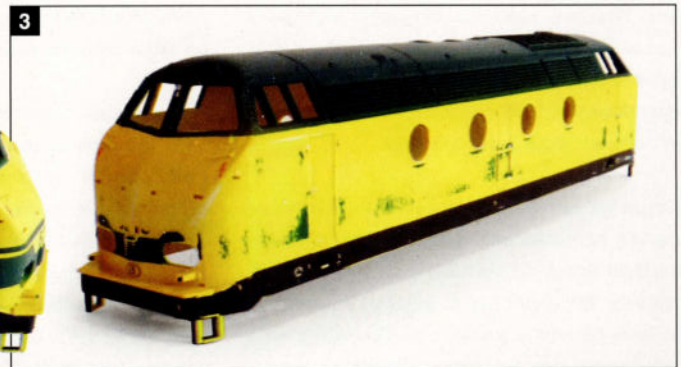
Photo 3: Soyez prudent lors du ponçage: toutes les inscriptions et les lignes vertes doivent être éliminées. Après quoi, la caisse est prête pour une petite couche de fond (primer).
