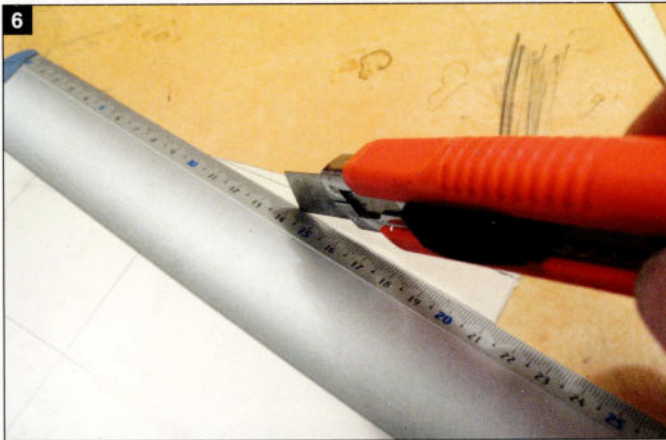
Photo 6. Les éléments sont soigneusement découpés à l'aide d'une lame bien tranchante, prenant appui sur une latte métallique. Il n'est pas nécessaire de couper la totalité de l'épaisseur. Quelques passes bien appuyées suffiront et le reste viendra par cassure.
