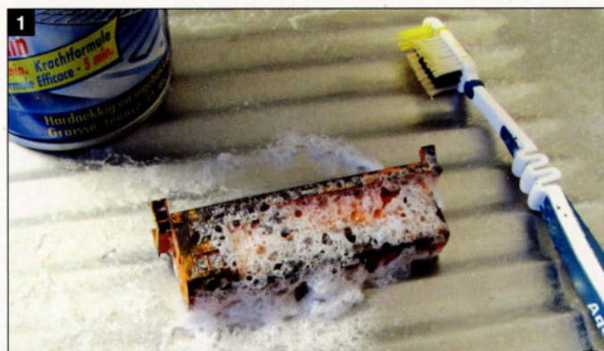
1: Le modèle est aspergé de Decap four pour une durée de deux à trois heures à chaque fois. Pour plus d'efficacité, l'opération s'effectue dans une boîte hermétique.
