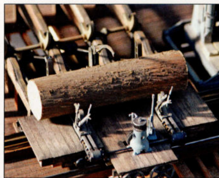
Le tronc sur le chariot de découpe (le carriage) peut être exactement disposé grâce aux 'bunks'.
