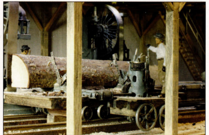
Le 'carriage' (chariot de découpe) avec tronc est tracté le long du 'Head-saw' au moyen du cylindre à vapeur.
