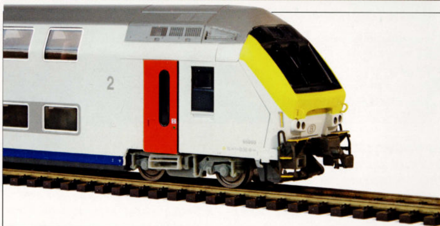
Les marchepieds pour agents de triage, l'attelage automatique et les essuie-glaces sont très filigranes.
