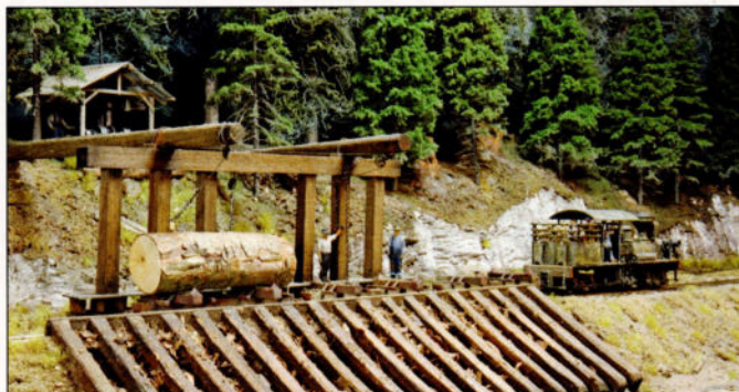
Les troncs sont déchargés des deux premiers 'Skeleton log cars'. On voit bien ici que grâce au 'gauntlet', les wagons circulent plus près du 'log dump' que la loco, et comment les traverses des wagons de bois dépassent de la balustrade du 'log dump'.
