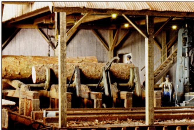
Le 'rollway' et le 'log loader', où la réserve de troncs est prête.
