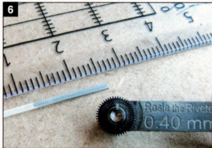
6: La réalisation d'une bande rivetée en carton grâce à une roulette issue du domaine du maquettisme. Un essai nous démontre que la peinture n'atténue pas les détails.
