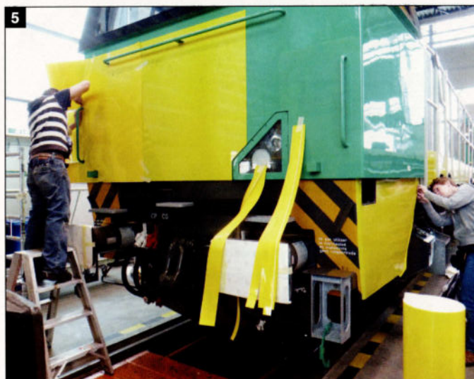
5: Plus aucun pinceau n'est nécessaire: la G2000 d'Angel Trains reçoit sa nouvelle 'peau' par pose d'adhésifs.
