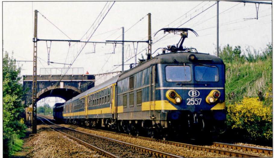
Une rame réversible Benelux de la 1ère génération se dirige vers Bruxelles, le 16 mai 1985. Derrière la locomotive électrique 2557 de la SNCB, on reconnaît une voiture I4 A, une voiture I4 AB, trois voitures NS de 2ème classe Plan W2 et une voiture-buffet-pilote des NS. Durant les premières années de circulation des rames réversibles Benelux de 1ère génération, les voitures I4 A et I4 AB de la SNCB étaient classées entre la voiture-pilote des NS et les trois voitures de 2ème classe 'Plan W2' des NS. La locomotive et les voitures arborent la première livrée Benelux bleue, avec bande jaune. Photo : Max Delie
