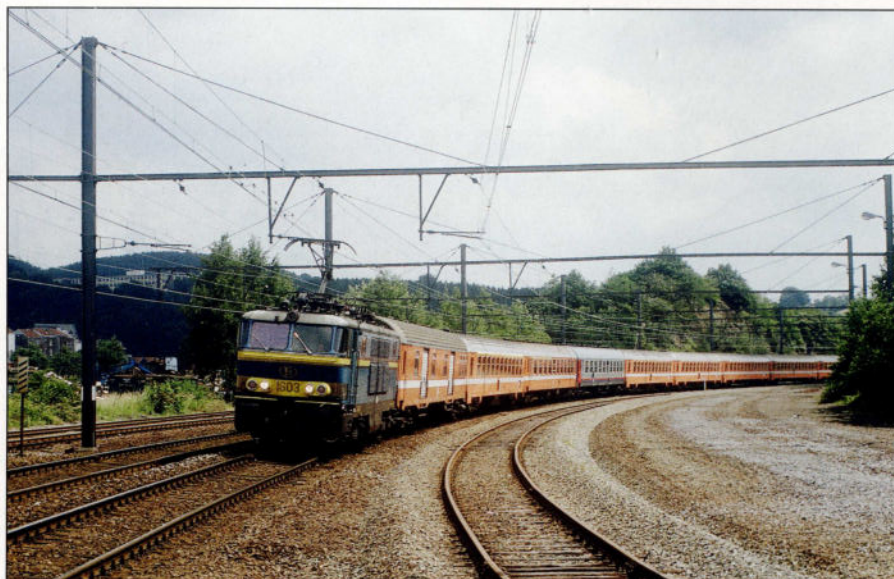
Un train IC Cologne – Ostende traverse la gare de Verviers-Est, le 19 juin 1993. La rame arbore presque entièrement la livrée orange C1, excepté la voiture I4 ABK, qui arbore la fameuse livrée Memling. Derrière la locomotive électrique série 16 sont classés successivement un fourgon Dms de la SNCB, une voiture I10 A de la SNCB en livrée C1, une voiture I4 AB en livrée C1 remplaçant une voiture I10 A indisponible, la voiture I4 ABK en livrée Memling, quatre voitures I10 B de la SNCB et une voiture I6 B de la SNCB qui à l'époque, n'était en théorie plus incorporée dans les rames des IC Cologne – Ostende. Photo : Michel Van Ussel.
