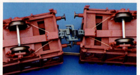
Plus la courbe est serrée, plus la plaquette supportant l'essieu pivote!
