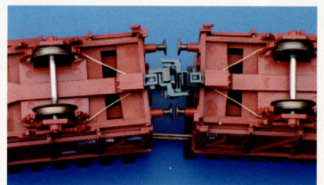
Pliez le fil vers l'avant jusqu'à ce que les deux extrémités de fils se touchent.
