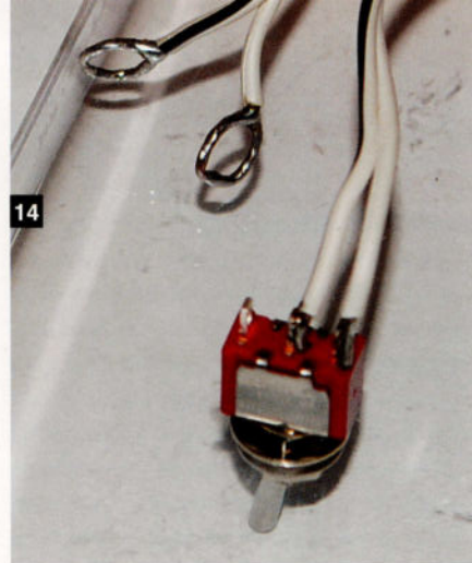
14. Soudez deux fils au contact de l'interrupteur et confectionnez deux œillets aux autres extrémités. Faites attention: il s'agit bien d'un interrupteur, et non d'un bouton-poussoir!
