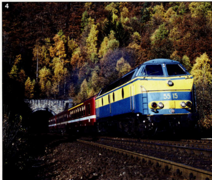
4. Les 55 'bleues' étaient indissociables de la relation IR Liège – Luxembourg. Voici la 5515 avec sa rame habituelle de voitures M4 à la sortie du tunnel de Trois-Ponts, en route vers Vielsalm. Cette courte rame est composée d'une 'AD' mixte 1ère classe/fourgon et de deux 'B' de 2ème classe, une composition qui peut aisément être reproduite au moyen des M4 de Lima ou d'OsKar. Photo: Max Delie; novembre 1989.
