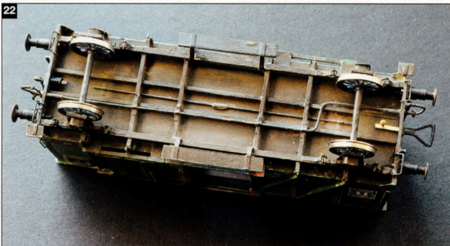
22. Afin de pouvoir monter l'attelage pour le système Fleischmann, une fente doit être pratiquée dans la traverse de tête. La barre de l'attelage à boucle doit être limée pour devenir plane et pourvue en outre d'un trou dans lequel la clavette de l'attelage sera insérée ultérieurement. Des variantes d'attelage pour Märklin et Roco – qui doivent être positionnées plus profondément – pourraient également être montées sous la traverse de tête. A gauche à l'image, l'attelage à vis monté au moyen d'un bout de tuyau rigide, qui s'est avéré suffisant amplement lors des premiers essais. Le jeu latéral sera pour plus tard, lorsqu'il sera question de l'attelage à vis, sur l'autre face d'about du wagon. Ici aussi, vous pouvez remarquer le résultat de l'utilisation d'une 'ancienne' peinture pour la partie inférieure de la caisse du wagon. Quant à savoir si les résidus de cette ancienne peinture peuvent encore être poncés, c'est une autre question...
