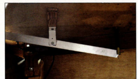
Le levier sous la table actionne l'ascenseur à wagons de façon aisée et souple.
