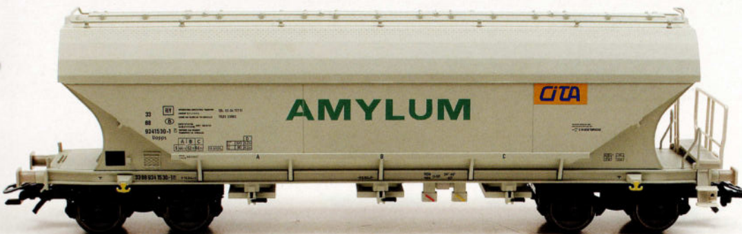
Wagon en livrée beige foncée portant une grande inscription 'Amylum' et un petit logo 'Cita' sur fond jaune, du type 'Uapps' avec matricule 33 88 9341530-1P. Destiné au transport de céréales, propriété de la Cita à Bruxelles, gare d'attache: Gand-Maritime. Le marquage est noir (sauf 'Amylum', en lettres vertes).
