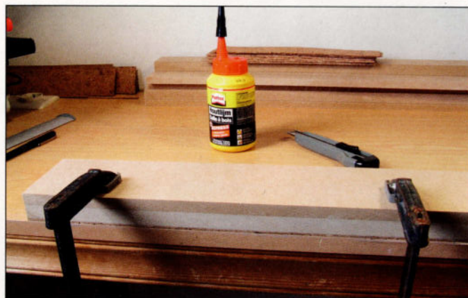
L'emploi de serre-joints est utile pour coller le liège correctement. Ici, lors de la fabrication des étagères.
