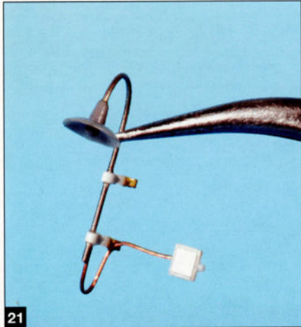
Photo 21 : Pour prolonger ce bref aperçu, gros plan sur une autre construction. Remarquez les colliers réalisés avec des bandelettes de carte plastique de 12/100 enroulées autour du bras en maillechort. Les pattes de fixation sont quant à elles réalisées avec des «éclisses» LSL coupées en deux et soudées à la cyano. Notez également le petit boîtier électrique créé de toutes pièces avec de la carte plastique de 25/10 et 12/100.
