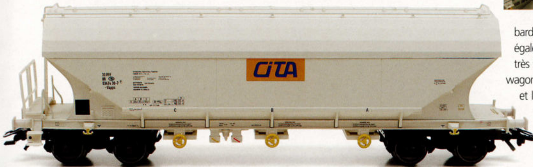
Wagon en livrée crème avec petit logo 'Cita' sur fond jaune, du type 'Uapps' portant le matricule 33 88 93414 38-7P. Destiné au transport de céréales, propriété de la firme Cita à Bruxelles, gare d'attache: Gand-Maritime. Son marquage est noir.
