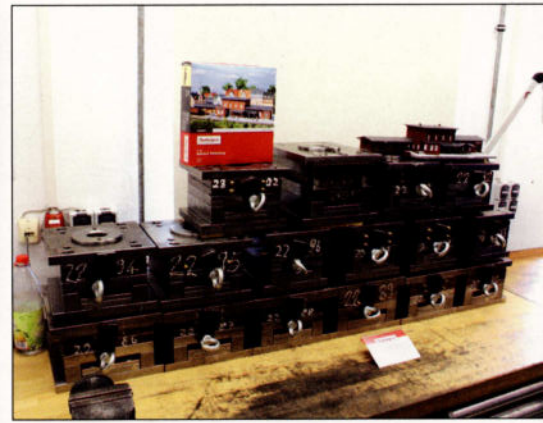
Les moules métalliques pour la confection du travail d'injection de plastique. Tous ces moules sont nécessaires pour une seule boîte de construction.
