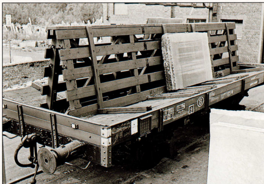
Sur cette photo sortie des archives du Groupe SNCB, on voit nettement que le pupitre reproduit par Goover Models manque encore de certains éléments nécessaires. Les traverses de renfort verticales doivent encore être apposées, et remarquez sur le bord du wagon les fixations des ranchers horizontaux, montés après le chargement du wagon.
