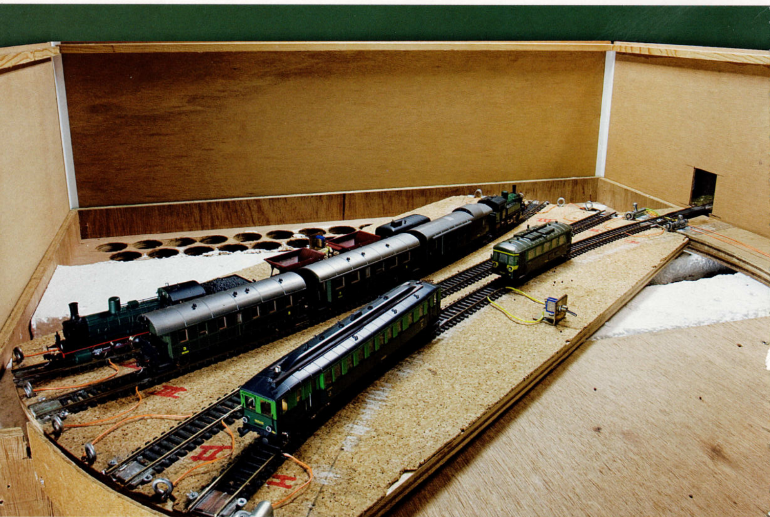
La gare fantôme – par ailleurs terminus de la ligne – est constituée d'une plaque tournante à quatre voies. Les trains peuvent y être virés, sans devoir les toucher !
