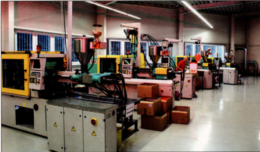
Le hall de fabrication contenant cinq machines d'injection est propre et ordonné. Ces nouvelles machines d'injection garantissent à l'avenir des produits de grande qualité.
