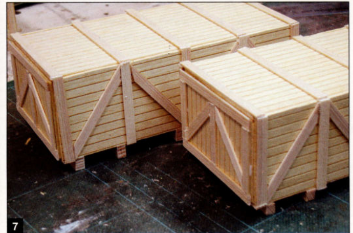
(regardez d'abord à quoi ressemble une telle caisse, en réalité). Sous la caisse, des traverses plus lourdes sont posées. Aux raccords des lattes, des petits trous de clous sont réalisés au moyen d'une fine pointe de fer à souder.
