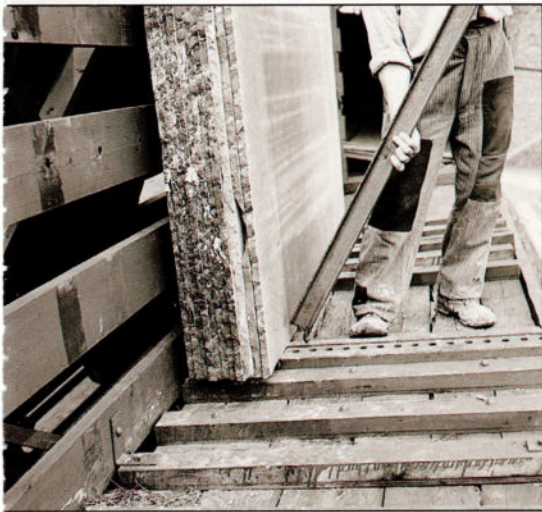
15 16 Après chargement du wagon, des ranchers métalliques sont fixés à la structure du plancher du wagon, avec leur crochet vers le bas. Ces ranchers veillent à ce que le chargement ne se déplace pas lors du transport (Photo : Groupe SNCB)
