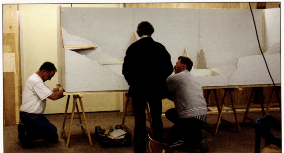
Les bacs de modules sont confectionnés au moyen de multiplex imperméable, très solide. L'assemblage l'est également, afin que les bacs ne se déforment pas sous les nombreux kilos de rochers en plâtre...
