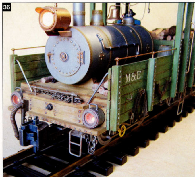
36- Le bloc avant réalisé à l'aide de divers profilés en bois.
