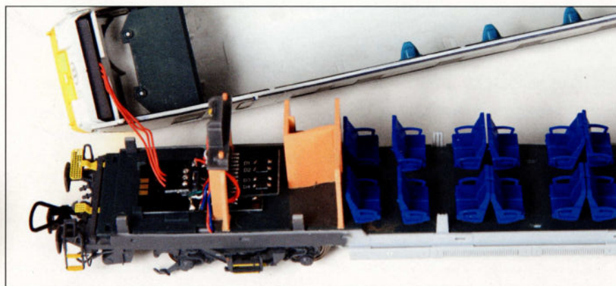
Les phares sont commandés par un module électronique disposé sous le poste de conduite, avec un espace libre pour un décodeur.
