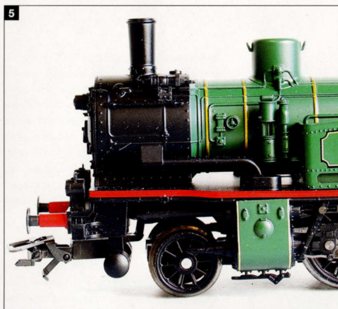
5. La face gauche du modèle Märklin présente une dynamo Schmidt, typiquement allemande: ce type d'appareillage n'était pas utilisé sur les locos belges. On y remarque également les mains courantes et les conduites moulées, ainsi que la pompe d'alimentation pour le réchauffeur Knorr. Ces appareils n'étaient pas présents sur une loco belge et sont donc superflus sur ce modèle. Quant à la cheminée, elle est d'origine allemande.
