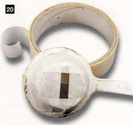
Photo 20. Semer sur un millimètre carré! Pour que le long du lit de ballast, les gravillons fins des sentiers soient éparpillés le plus possible sur la piste de circulation, le diamètre du tamis peut être réduit.
