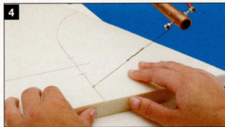
Photo 4. En poussant la plaque PU lentement contre le fil de découpe, on obtient des coupes nettes et franches.
