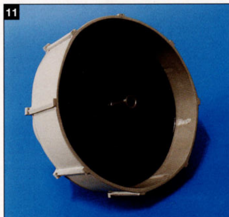
11. Lorsque la cuve est entièrement peinte – tant à l'intérieur qu'à l'extérieur – la masse d'eau est apposée. Des dégâts peuvent survenir alors à la couche de peinture, ce qui est facile à retoucher par après au pinceau.
