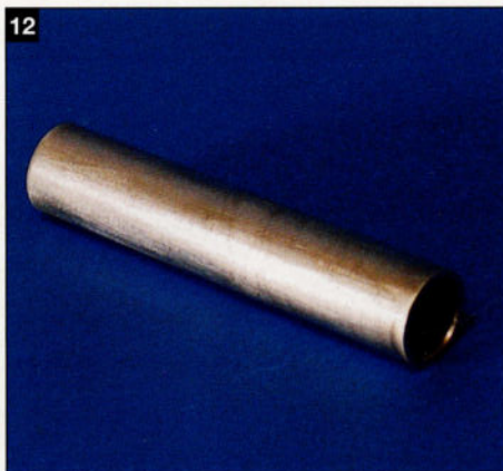
12. La petite buse en métal du trop-plein doit être peinte avant de la disposer dans la masse d'eau.
