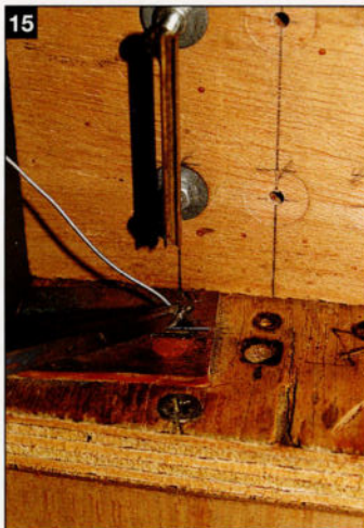
15: Appliquez suffisamment de soudure tant sur l'éclisse que sur la partie supérieure du mât, glissez le profilé le long du guide vertical disposé sur le moule jusque contre l'éclisse et soudez les deux pièces l'une à l'autre.
