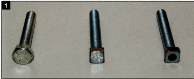
1: De gauche à droite: un boulon non modifié, un boulon fraisé en carré et un boulon fraisé avec trou central.
