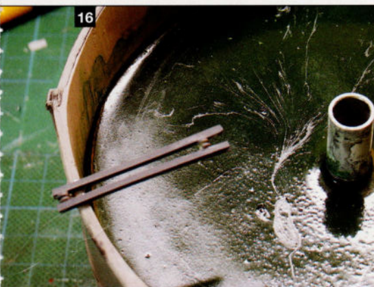
16. Les supports des poulies sont collés au-dessus de la cuve, bien au milieu entre les deux colonnes de soutien.
