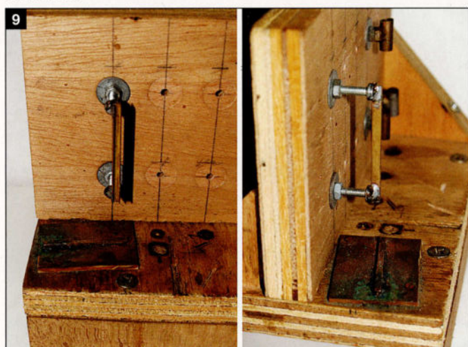
9: Voici le moule utilisé pour assembler l'éclisse sur la partie supérieure du mât: nous le décrirons plus tard.
