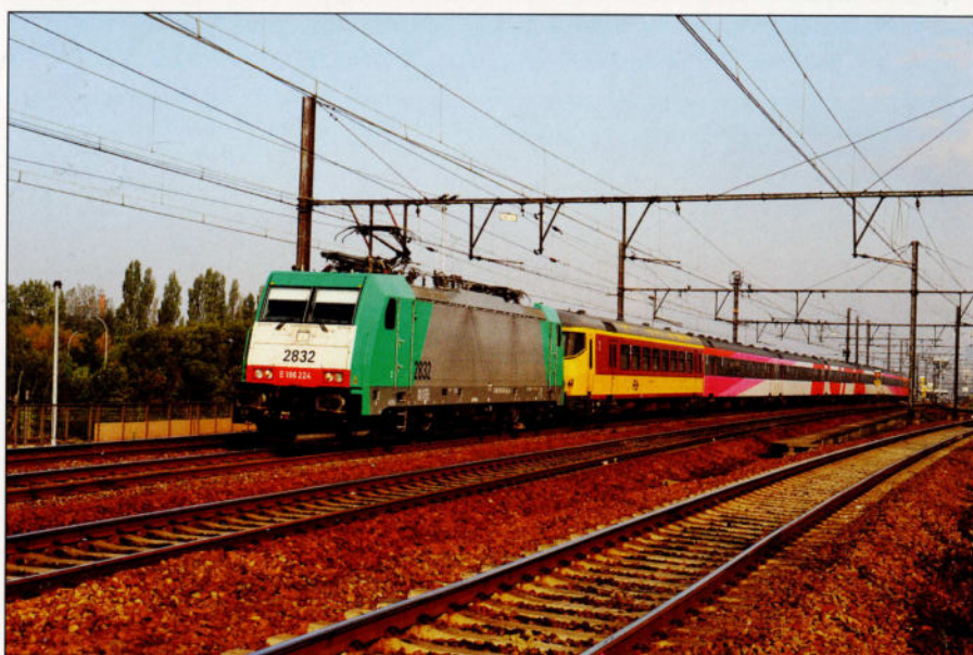
La 2832 en tête d'un train Benelux, composé d'une rame homogène de voitures NS en livrée 'Prio'. La voiture-pilote – toujours en livrée Benelux d'origine – n'est plus fonctionnelle.
