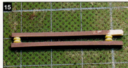
15. L'assemblage de l'indicateur du niveau d'eau est le seul travail d'assemblage nécessaire pour ce kit. En voici la première étape: la pose de poulies entre les traverses. Utilisez pour ce faire de préférence de la colle instantanée.
