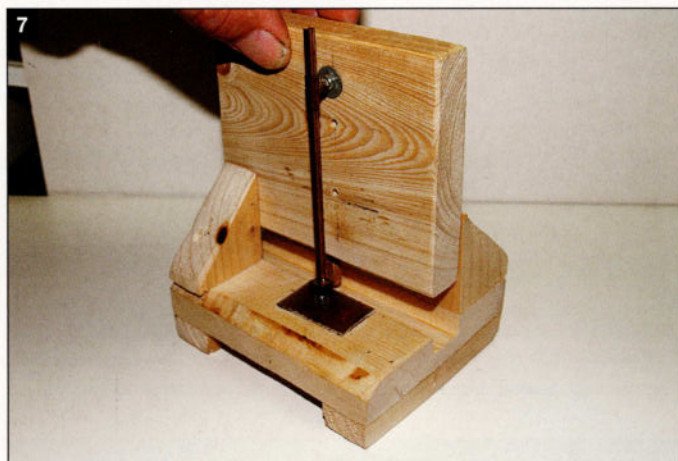
7: Lorsque tout a bien refroidi, vous pouvez enlever la partie supérieure du moule...
