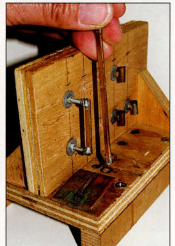
16: Après refroidissement, le mât peut être écarté avec précaution de son guide vertical afin de le détacher ensuite de son guide horizontal.
