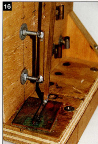
16: Après refroidissement, le mât peut être écarté avec précaution de son guide vertical afin de le détacher ensuite de son guide horizontal.
