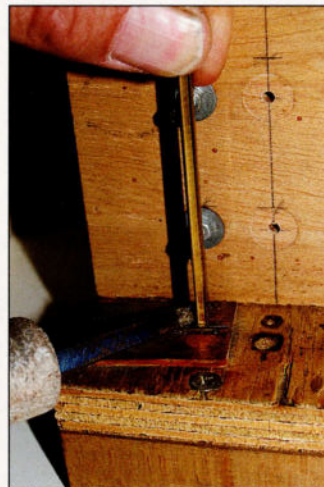
15: Appliquez suffisamment de soudure tant sur l'éclisse que sur la partie supérieure du mât, glissez le profilé le long du guide vertical disposé sur le moule jusque contre l'éclisse et soudez les deux pièces l'une à l'autre.
