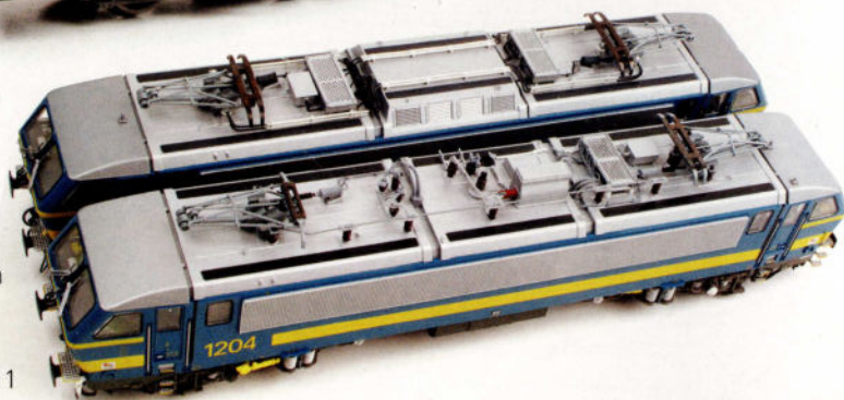
Comparaison entre les toitures des séries 27 et 12.
