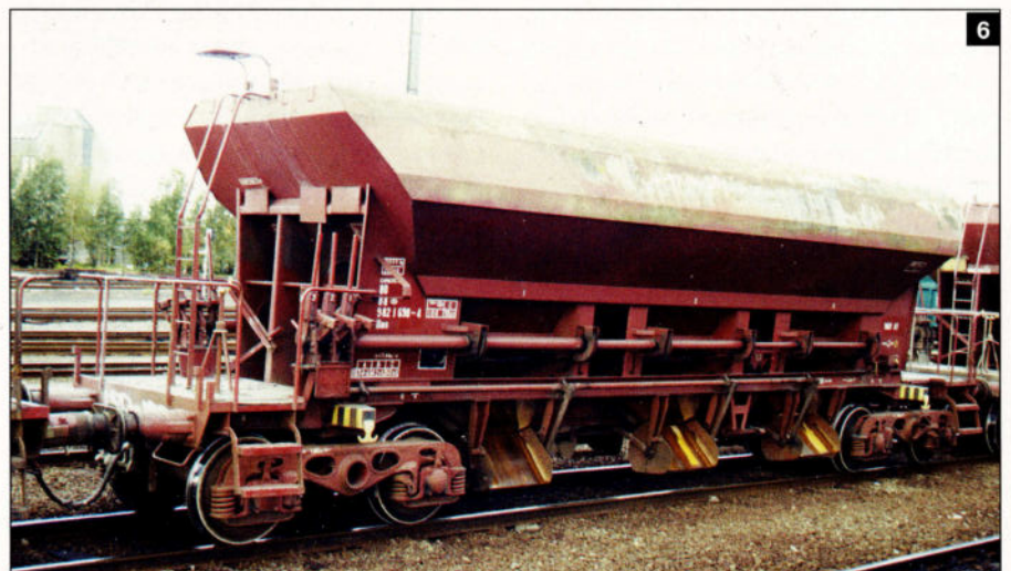
6. Un wagon de ballast du type 9821 A 3 'Uas' avec matricule 80 88 982 1 690-4 à Mons, le 30.10.1996. Photo: Bart Luyten.
