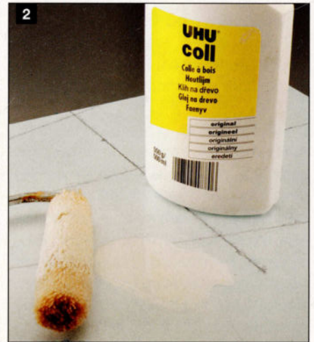
2. De plus grandes surfaces peuvent très bien être fixées avec de la colle blanche pour bois. Au moyen d'un petit rouleau pour peinture déclassé, la colle peut être étalée sur toute la surface de collage.
