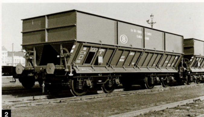
2. Ce wagon de minerais des 'Forges de Clabecq' est identique à celui reproduit par LS Models, sauf pour ses boîtes d'essieu (Photo : Groupe SNCB).
