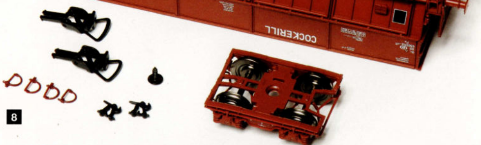
8. La partie inférieure du wagon de minerais. Le châssis est du type fermé, mais la timonerie de freins est bien reproduite (photo: PE)
