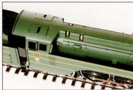
La chaudière a été pliée d'une pièce. La plupart des pièces y ont été soudées. Toutes les vitres de l'abri du machiniste peuvent être ouvertes.
