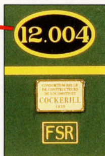
Le matricule de la loco est apposé dans un ovale jaune sur fond noir. L'indication de la remise de Schaarbeek est visible en dessous. Sur la plaque de constructeur, l'année de construction est très nettement visible. Le tender porte le matricule correspondant.
