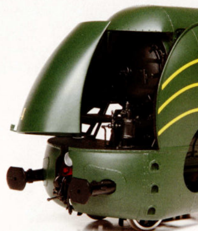
Une vue avant de l'engin, qui montre le fanal bien intégré et l'attelage à vis fonctionnel. Le modèle de la 12.001 est le seul à avoir les pla- teaux de tampons ajourés.
