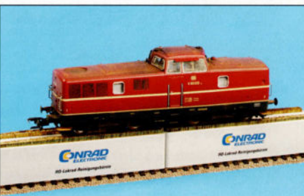
6. Pour les locomotives à empattement plus long, deux nettoyeurs peuvent être raccordés entre eux...
