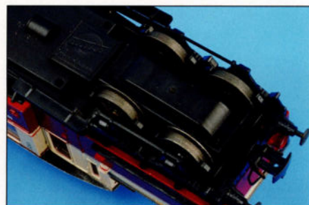
1. Les roues non chromées de ce modèle sont fortement oxydées, suite à un haut degré d'humidité.
