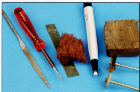
8. Voici des outils classiques pour l'entretien des roues. Mais faites attention avec ce type de matériel : nettoyer des roues avec une lime ou un outil tranchant (comme un tournevis) n'est pas une bonne idée, car le risque d'en- dommagement est réel.
