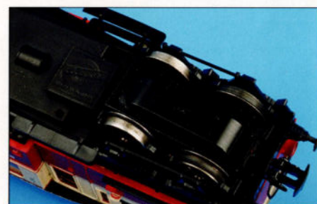
2. Les roues sont nettoyées après un traitement répété au moyen de la brosse. Lorsque cette loco sera à nouveau utilisée intensivement, ce ne serait pas une mauvaise idée que de remplacer les essieux par des neufs, suite aux bandages devenus rugueux et qui attirent la saleté.
